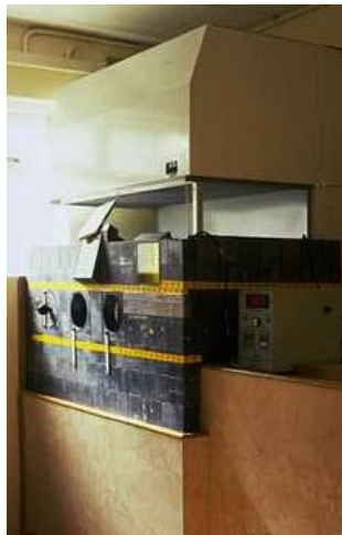
Abbildung 93: Bleiabschirmung um eine Flowbox in der Radiopharmaka hergestellt werden.
