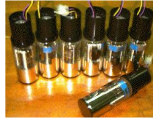
Abbildung 40: Einige identische Photomultiplerröhren von einer Gammakamera.
