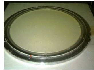
Abbildung 52: Der NaI Kristall einer Gammakamera.
