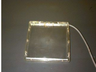
Abbildung 28: Ein Flächendetektor, wie er in der Radiographie verwendet wird
