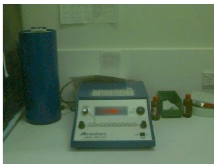
Abbildung 31: Ein in der Nuklearmedizin verwendeter Dosiskalibrator - der blaue Zylinder links enthält die reentrante Kammer
