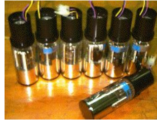
Abbildung 40: Einige identische Photomultiplerröhren von einer Gammakamera.
