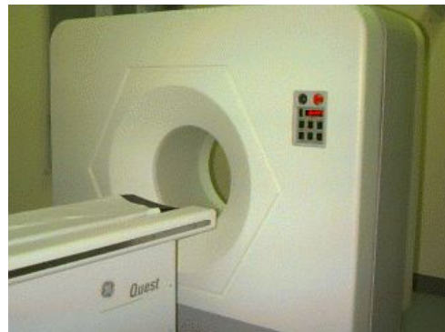
Abbildung 88: Der Scanner selbst mit den Detektoren unter der Abdeckung
