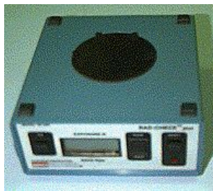
Abbildung 32: Ein Dosimeter wie es in der Radiographie verwendet wird.
