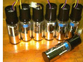
Abbildung 40: Einige identische Photomultipliertroden von einer Gammakamera.
