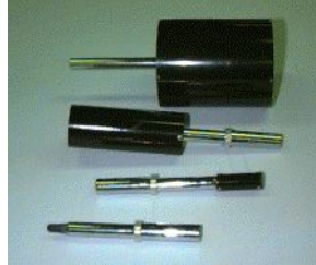
Abbildung 29: Einige Ionisationskammern mit unterschiedlichem Volumen zur Messung der Ionendosis.
