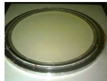
Abbildung 52: Der NaI Kristall einer Gammakame- ra.
