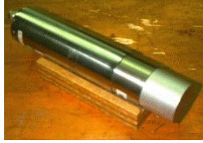
Abbildung 39: Ein NaI Kristall, der mit einem Photomultiplier verbunden ist.
