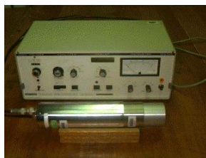
Abbildung 42: Ein Einkanalanalysator mit einem Kristall-Photomultiplier-Aufbau.
