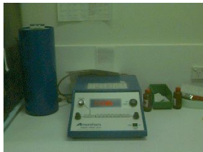
Abbildung 31: Ein in der Nuklearmedizin verwendeter Dosiskalibrator - der blaue Zylinder links enthält die reentrante Kammer
