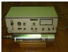
Abbildung 42: Ein Einkanalanalysator mit einem Kristall-Photomultiplier-Aufbau.
