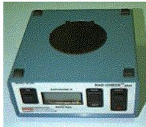
Abbildung 32: Ein Dosimeter wie es in der Radiographie verwendet wird.
