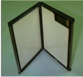
Abbildung 38: Eine Röntgenkassette, wie sie in der Radiologie verwendet wird
