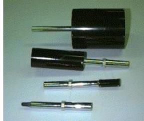
Abbildung 29: Einige Ionisationskammern mit unterschiedlichem Volumen zur Messung der Ionendosis.
