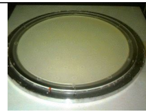
Der NaI Kristall einer Gammakamera.
