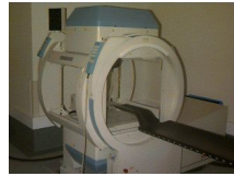
Einer Gammakamera mit zwei Köpfen.
