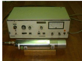
Ein Einkanalanalysator mit einem Kristall-Photomultiplier-Aufbau.
