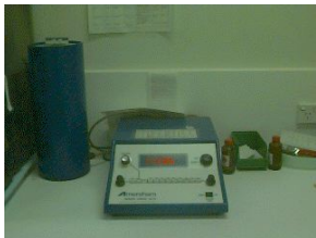
Ein in der Nuklearmedizin verwendeter Dosiskalibrator - der blaue Zylinder links enthält die reentrante Kammer
