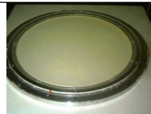
Der NaI Kristall einer Gammakamera.
