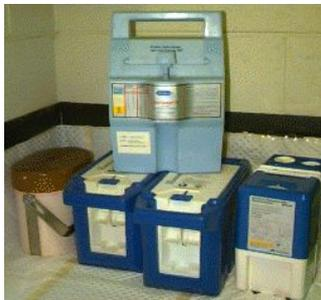
Fünf  $^{99\text{m}}\text{Tc}$  Generatoren.
