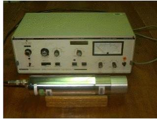
Ein Einkanalanalysator mit einem Kristall-Photomultiplier-Aufbau.
