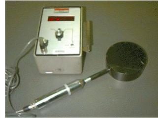
Ein Dosimeter wie es in der Radiographie verwendet wird.
