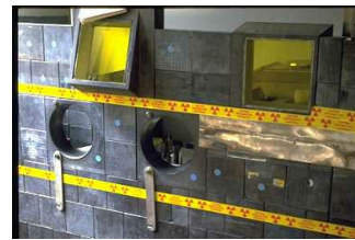
Die Bleiabschirmung um die Flowbox aus einer anderen Perspektive.
