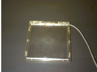
Ein Flächendetektor, wie er in der Radiographie verwendet wird
