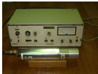
Ein Einkanalanalysator mit einem Kristall-Photomultiplier-Aufbau.
