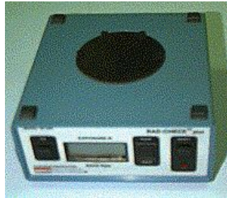
Ein Dosimeter wie es in der Radiographie verwendet wird.
