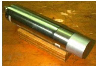
Ein NaI Kristall, der mit einem Photomultiplier verbunden ist.
