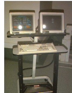
Das Bildbearbeitungsarbeitsplatz der Gammakamera mit zwei Köpfen.
