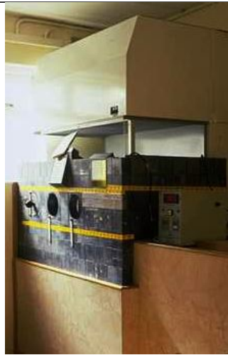
Bleiabschirmung um eine Flowbox in der Radiopharmaka hergestellt werden.
