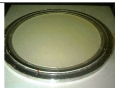
Der NaI Kristall einer Gammakamera.
