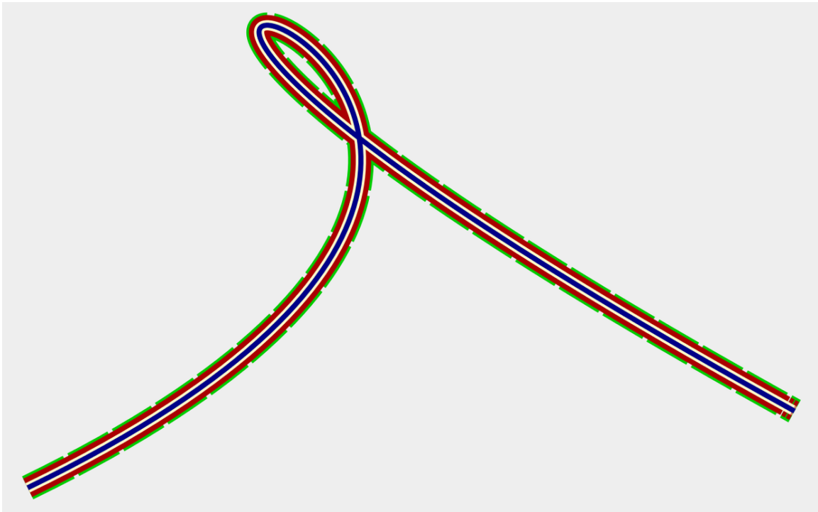
Abb. 86 Weglänge einer Kurve abschätzen durch Verwendung von stroke-dasharray als einfachem Maßstab
