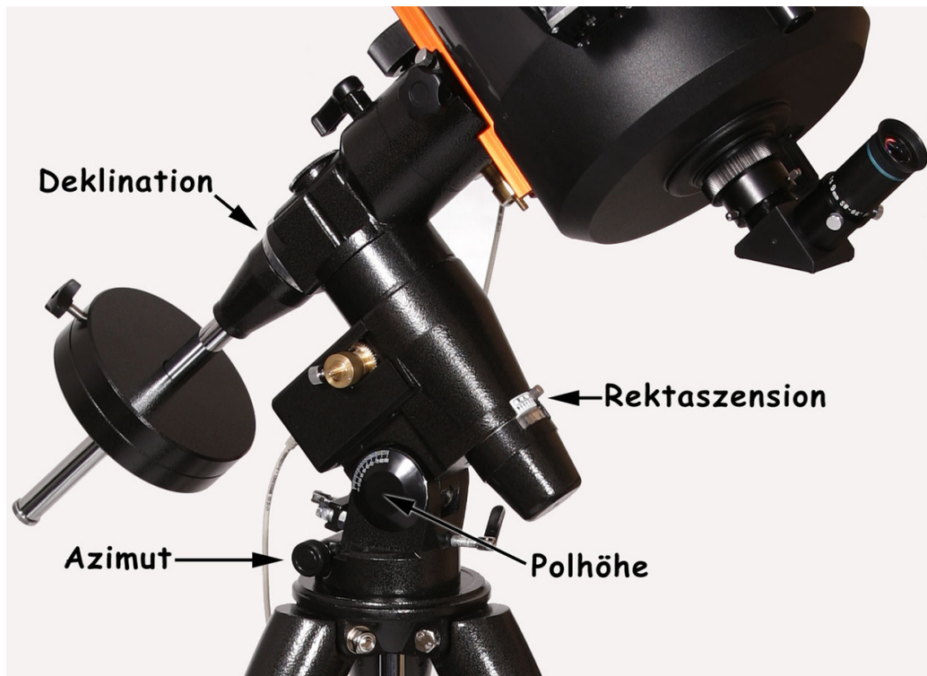
Abbildung 56: Deutsche Montierung und ihre Freiheitsgrade
