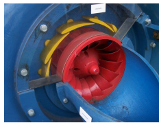
Abb. 16: Leitwerk einer Francis-Turbine für minimale Leistung eingestellt
