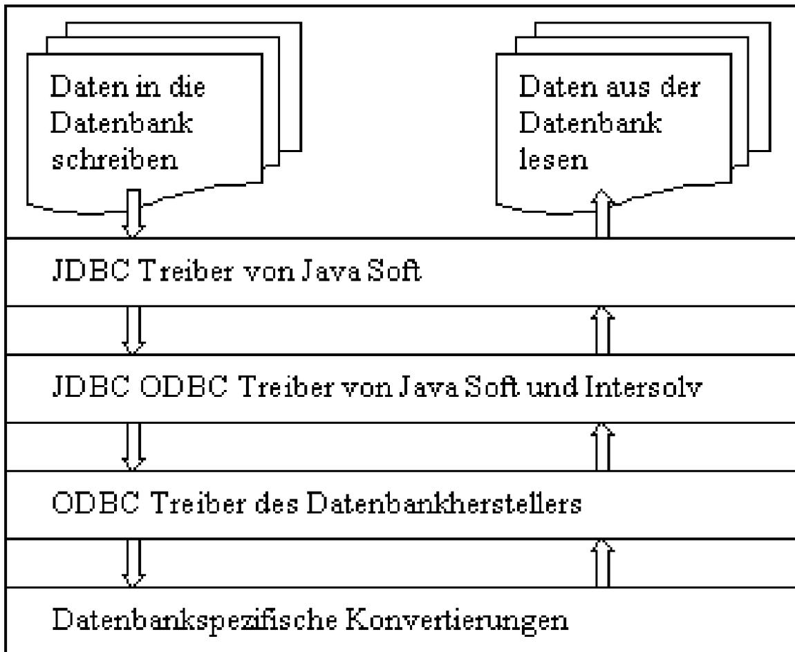
Abb. 10 Konvertierungen bei Datenbankzugriff über die JDBC ODBC Brücke
