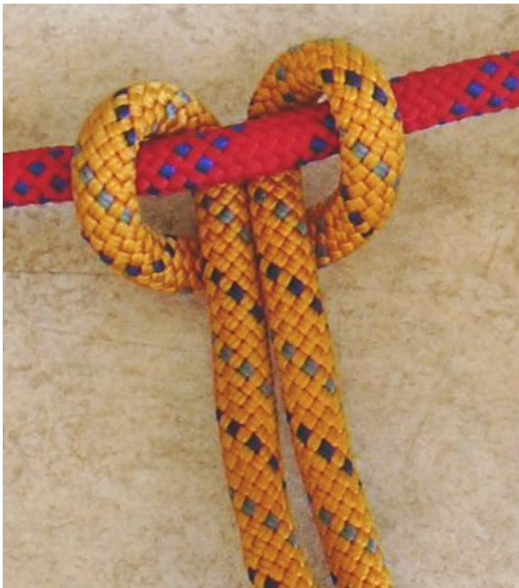
Abb. 36 Das orange Seil bildet einen Ankerstich um das rote Seil
