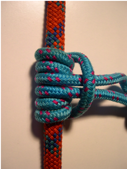
Abb. 22 Prusikknoten mit zusätzlicher Wicklung
