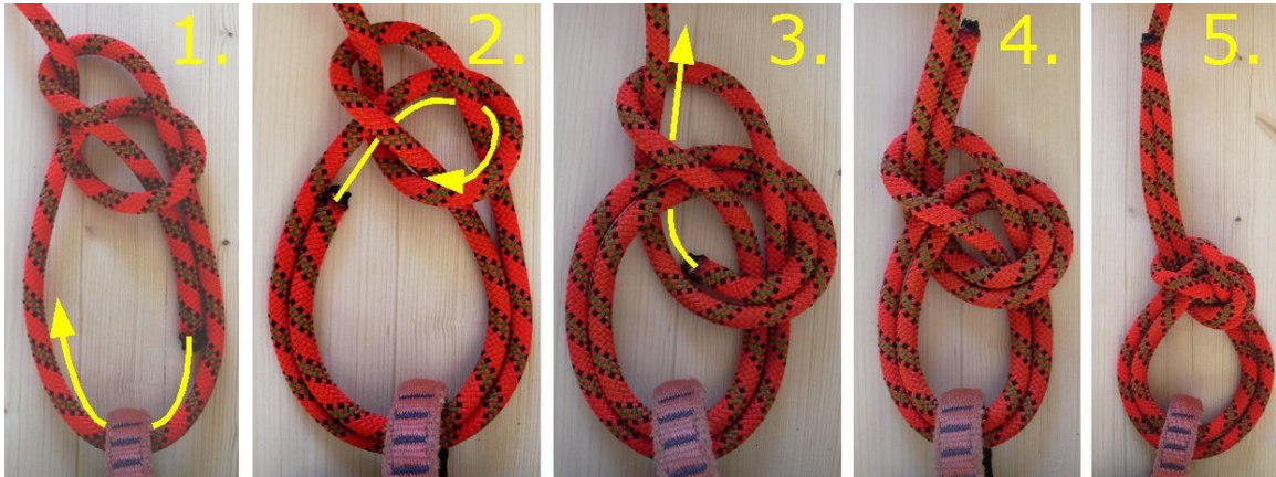
Abb. 20 Vom einfachen zum doppelten Bulin
