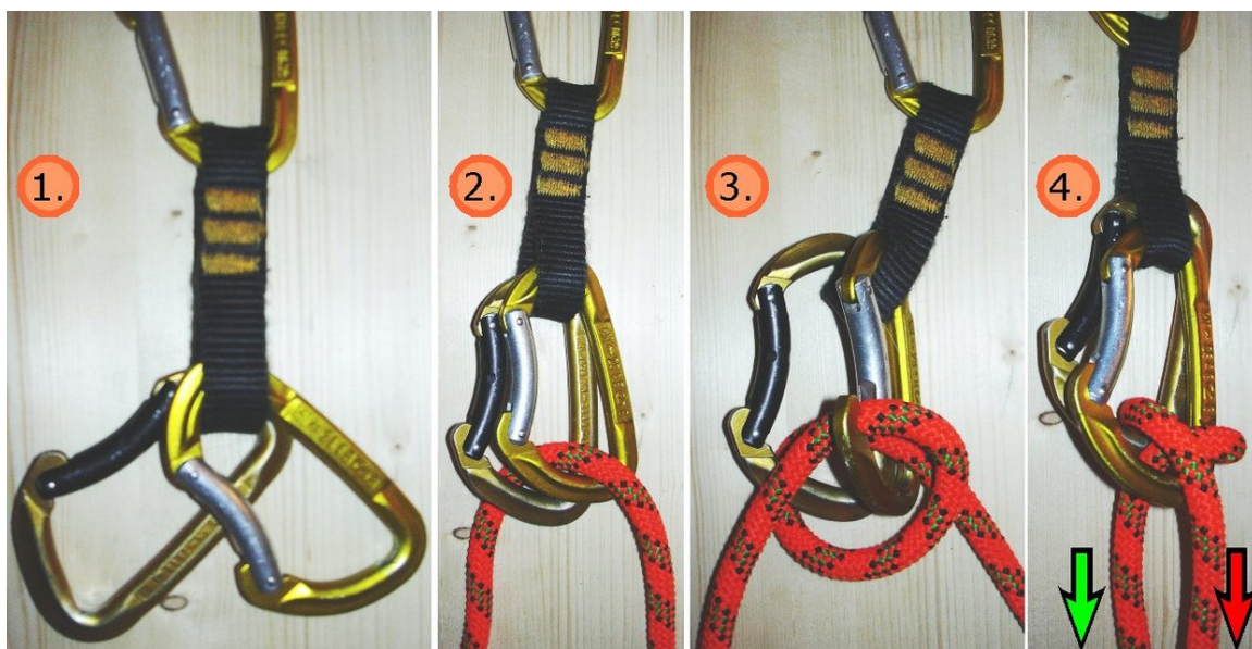
Abb. 27 Gardaknoten (auch Gardaschlinge), gegen den Uhrzeigersinn eingelegt
