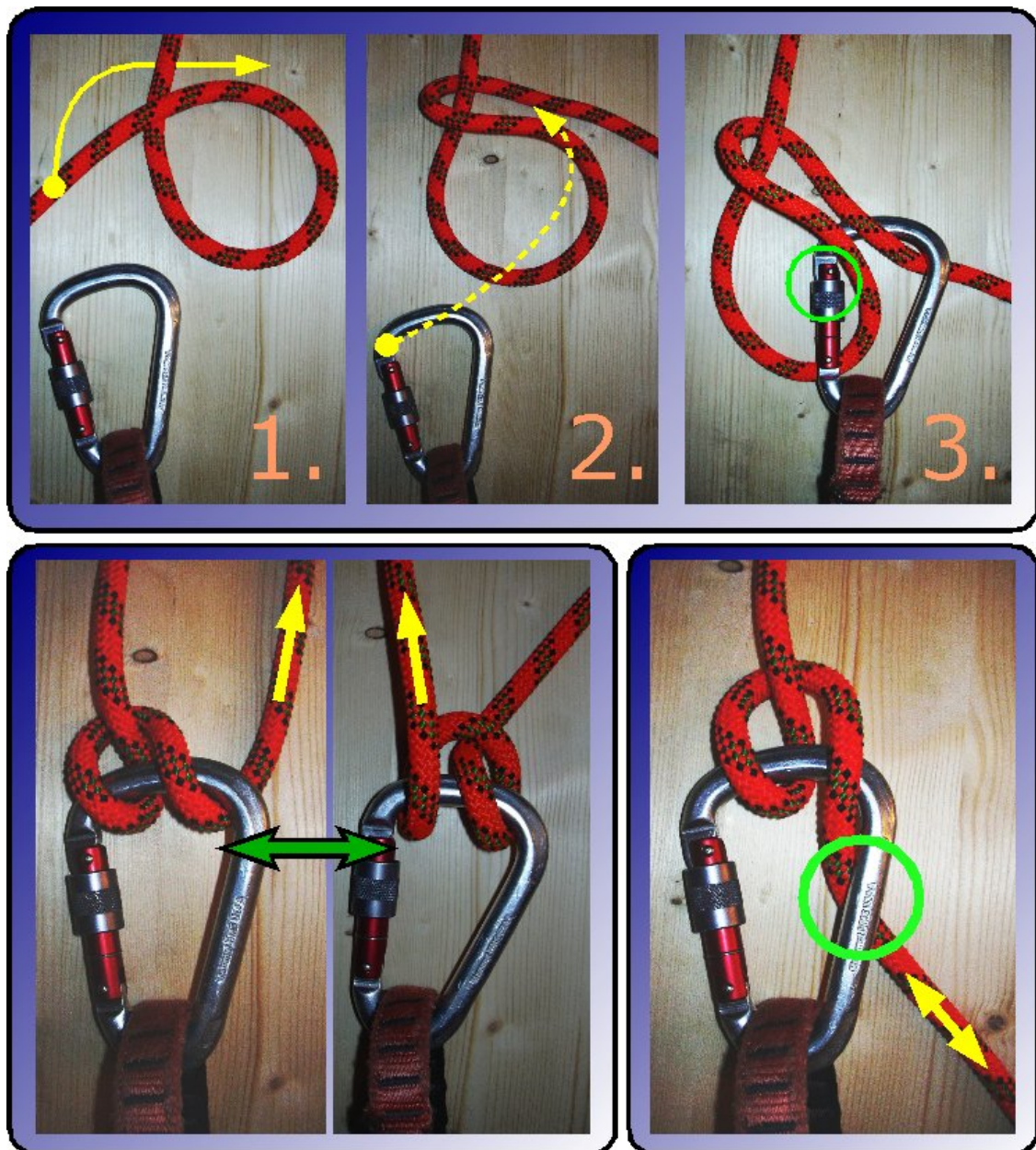
Abb. 7 Erstellung eines Halbmastwurfs , Umschlagen des Halbmastwurfs , Seilführung und Verschlusshülse
