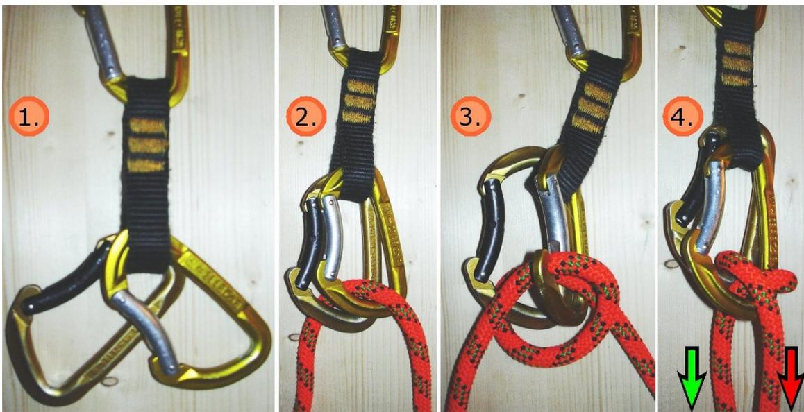
Abb. 26: Gardaknoten (auch Gardaschlinge), gegen den Uhrzeigersinn eingelegt
