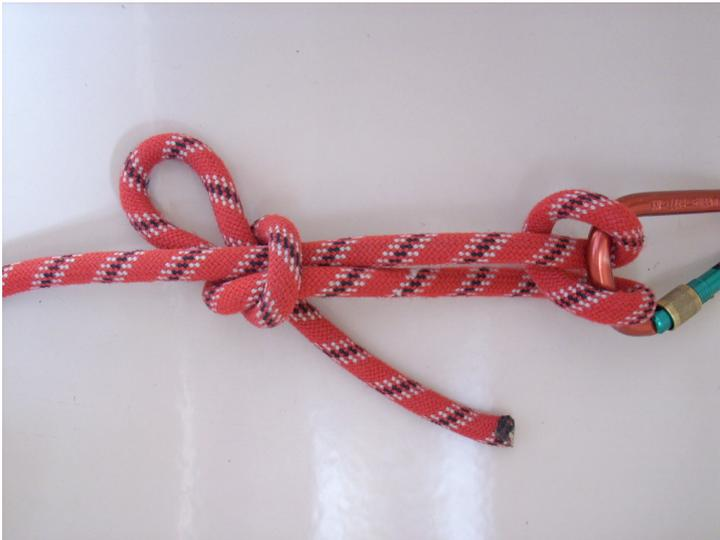
Abb. 37: Knüpfen eines *Schleifknotens*
