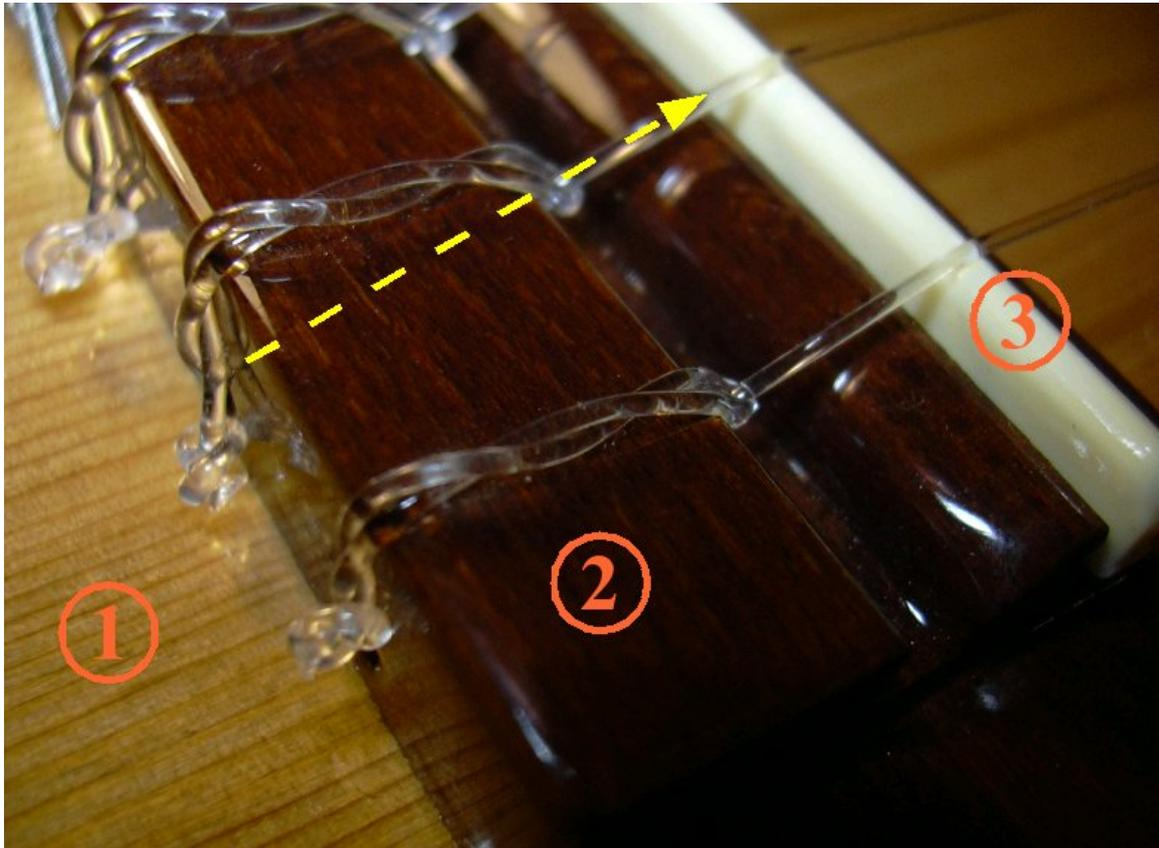
Abb. 39: *Zimmermannsschlag* beim Befestigen der Saite am Steg der Gitarre. (1) Gitarrendecke, (2) Steg, (3) Stegeinlage. Als gelber Pfeil dargestellt ist die Zugrichtung des Seils (hier: Saite), so dass der Knoten sich nicht löst.
