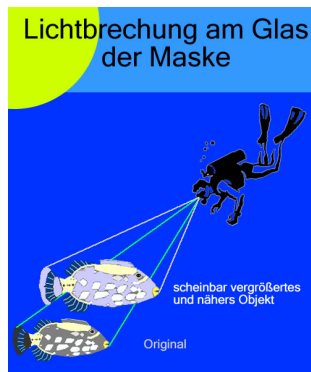
Abbildung 22: Wegen der Lichtbrechung an der Maske erscheinen Gegenstände um 1/3 vergrößert und darum auch 1/4 näher (Perspektive)
