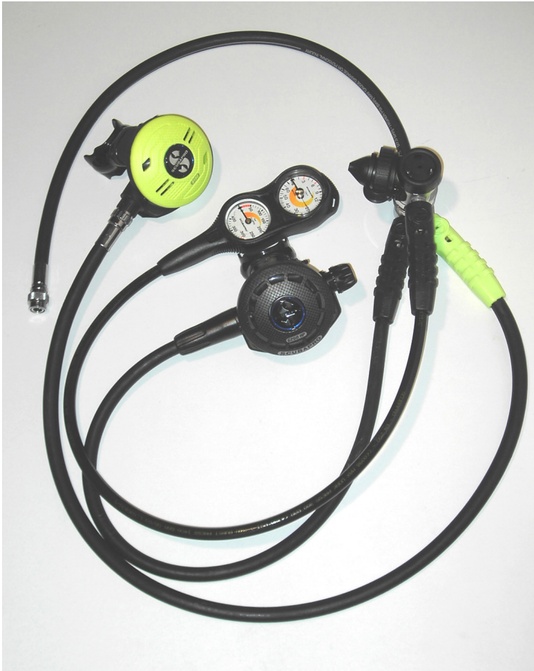
Abbildung 53: Vollständiger Lungenautomat mit Erster Stufe , zwei Zweiten Stufen (Octopussystem), Inflatorschlauch für Tariermittel und Konsole mit UW-Manometer und Tiefenmesser
