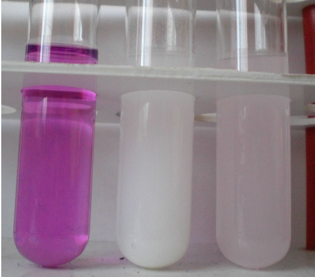
Abbildung 53: links: Permanganat; mitte: Lösung entfärbt, Bariumsulfat gefällt; rechts: Reaktion zu langsam
