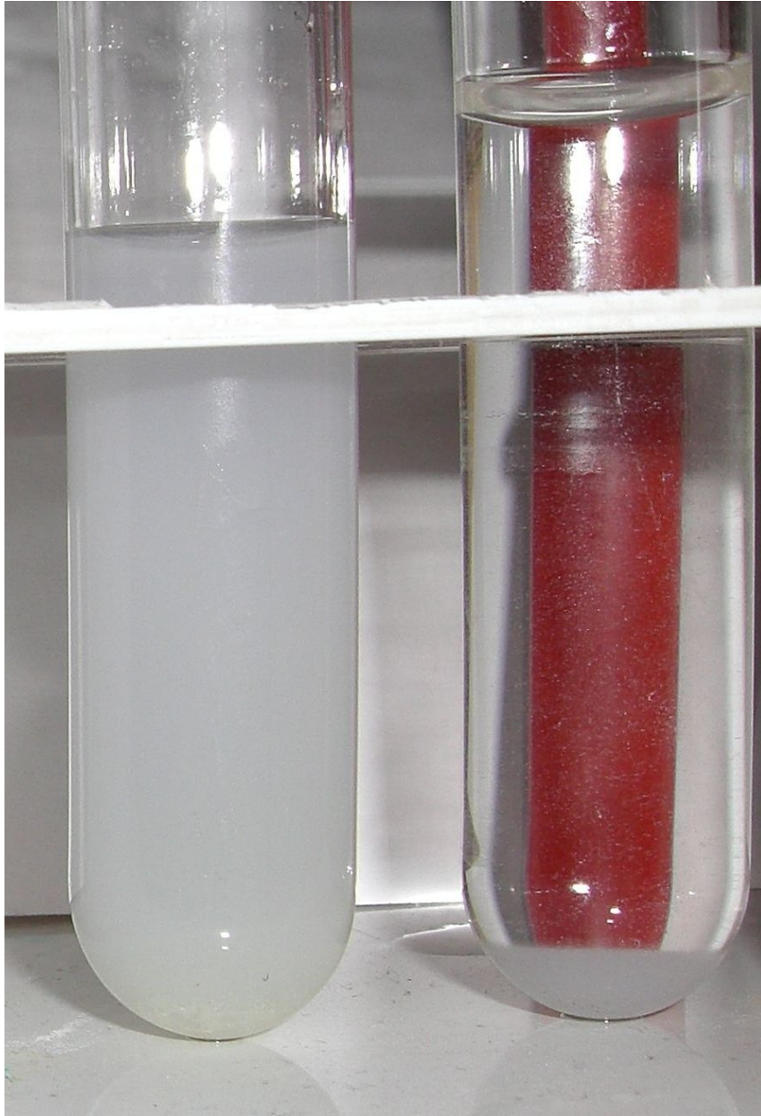
Abbildung 51: AgCl als weißer NS; rechts: AgCl gelöst in Ammoniakwasser
