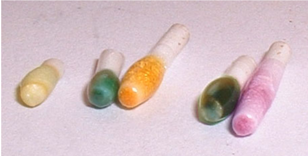
Abbildung 31: Phosphorsalzperlen: Ag, Cu, Ni, Fe und Mn
