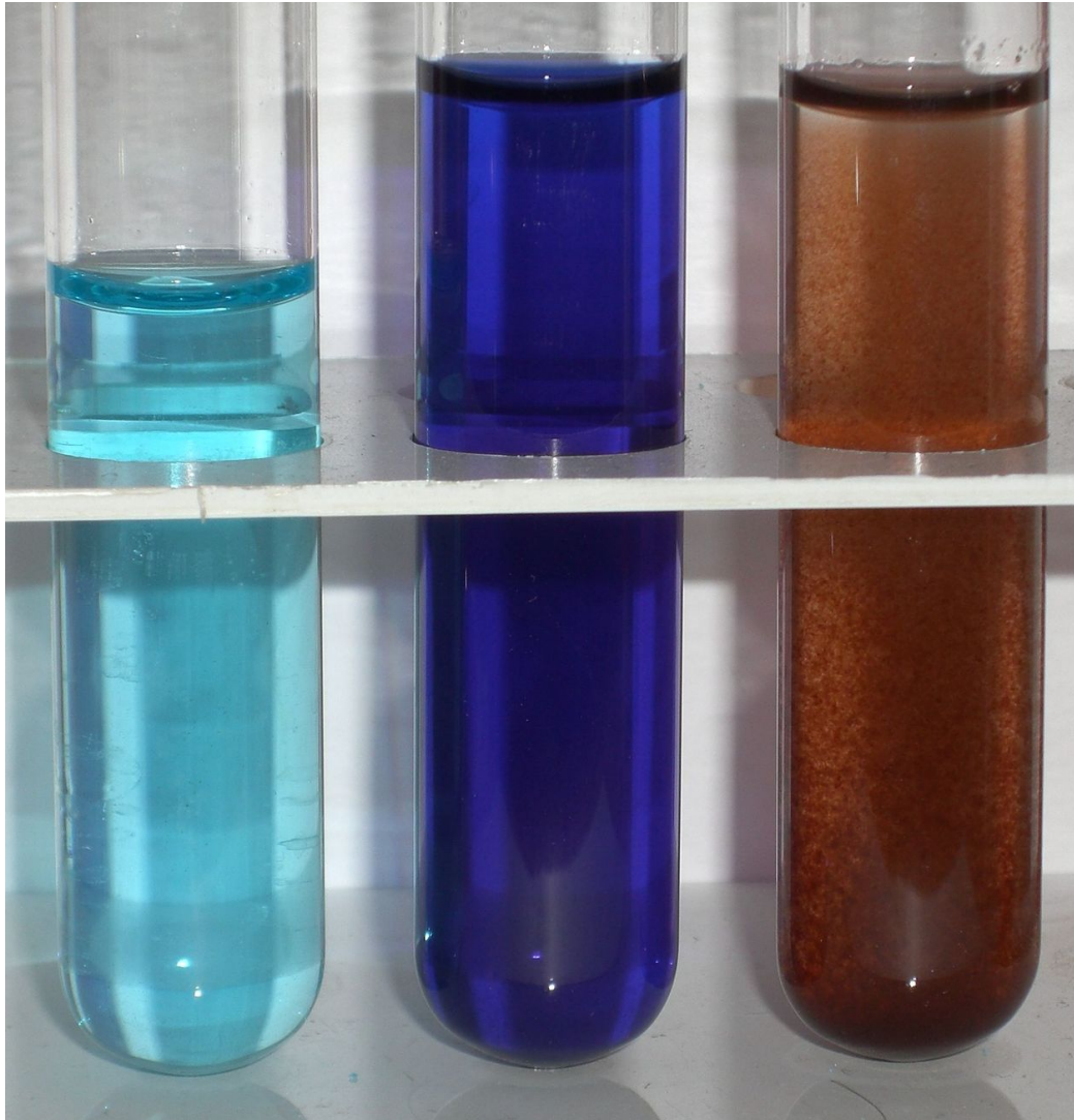
Abbildung 44: \text{CuSO}_4 (links), Nachweis als \text{Cu}(\text{NH}_3)_4 (tiefblau) als \text{Cu}_2[\text{Fe}(\text{CN})_6] (braunrot)
