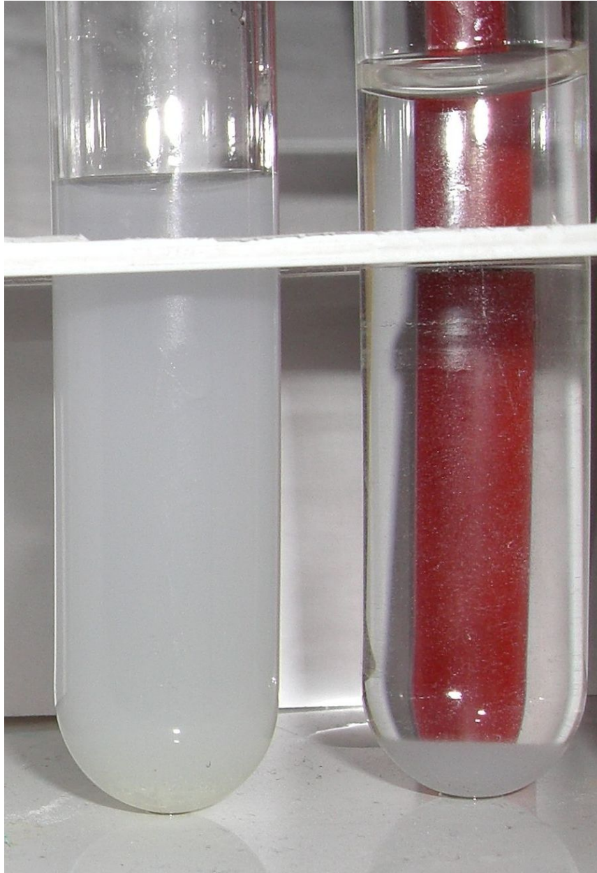
Abbildung 53: AgCl als weißer NS; rechts: AgCl gelöst in Ammoniakwasser
