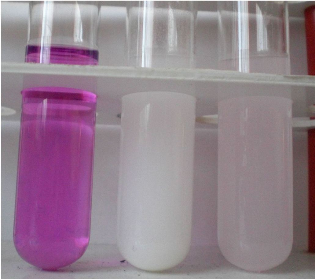
Abbildung 55: links: Permanganat; mitte: Lösung entfärbt, Bariumsulfat gefällt; rechts: Reaktion zu langsam
