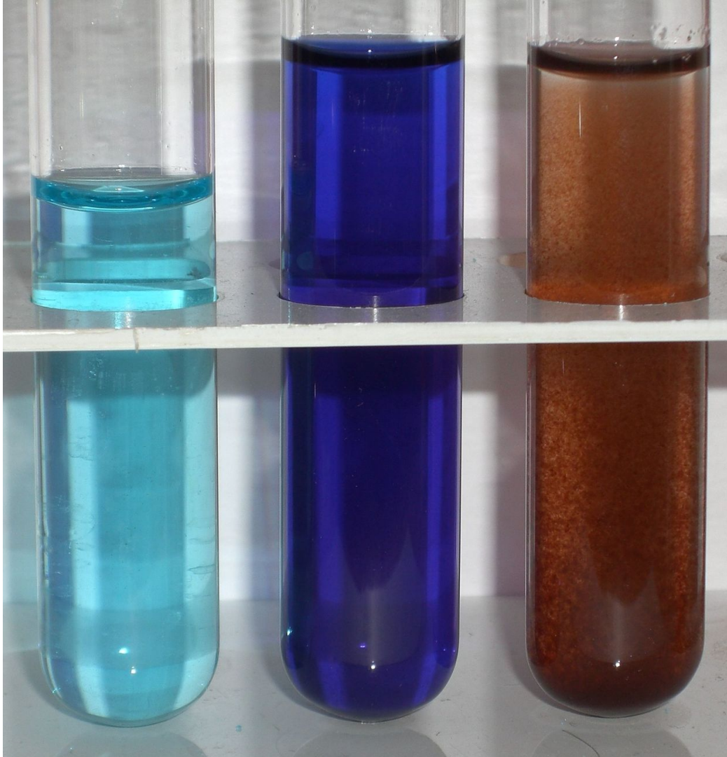
Abbildung 55: \text{CuSO}_4 (links), Nachweis als \text{Cu}(\text{NH}_3)_4 (tiefblau) als \text{Cu}_2[\text{Fe}(\text{CN})_6] (braunrot)
