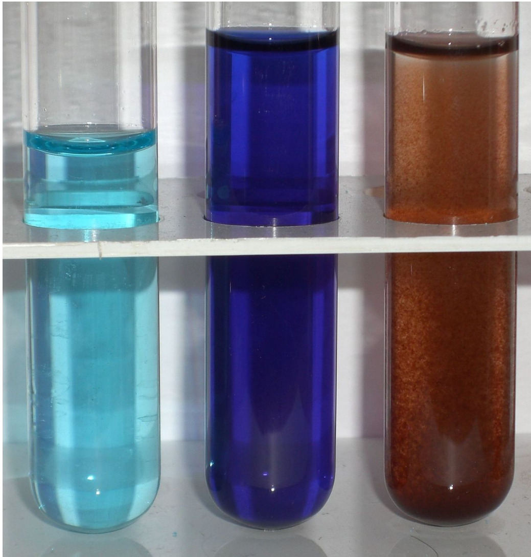
Abbildung 45: \text{CuSO}_4 (links), Nachweis als \text{Cu}(\text{NH}_3)_4 (tiefblau) als \text{Cu}_2[\text{Fe}(\text{CN})_6] (braunrot)
