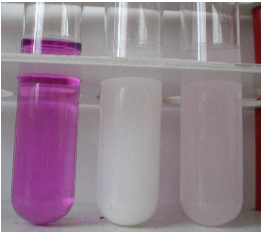
Abbildung 62: links: Permanganat; mitte: Lösung entfärbt, Bariumsulfat gefällt; rechts: Reaktion zu langsam
