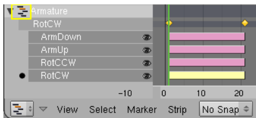
Abb. 1755: Abbildung 5: Der NLA-Editor mit vier Aktionen. Der gelb markierte Button schaltet zwischen Action (Einzelmodus) und NLA (Zusammengesetztem Modus) um. Im Bild gezeigt ist der NLA-Modus.
