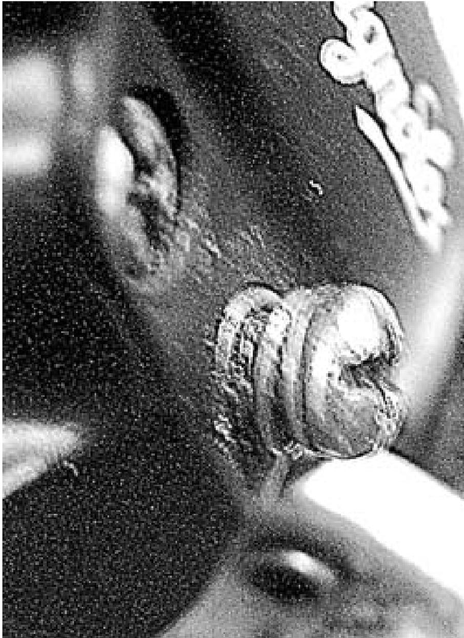
Abb. 11: Endanschlagschrauben
