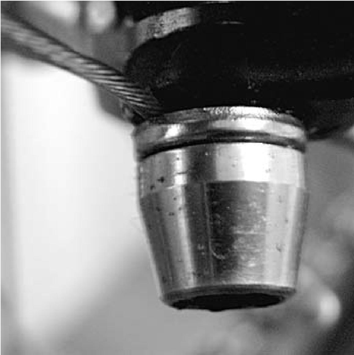
Abb. 9: Klemmschraube kontrollieren
