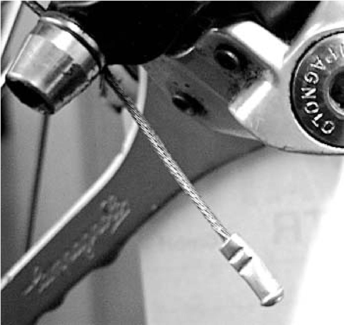
Abb. 8: Schaltzug kontrollieren
