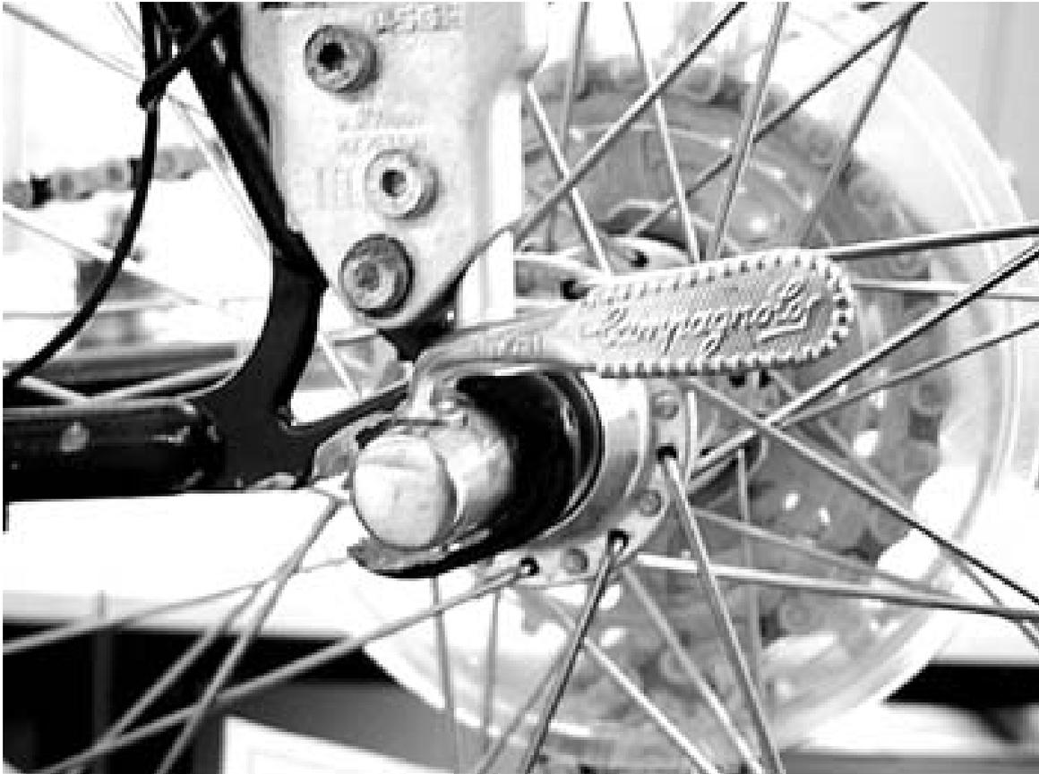
Abb. 6: Schnellspanner festziehen
