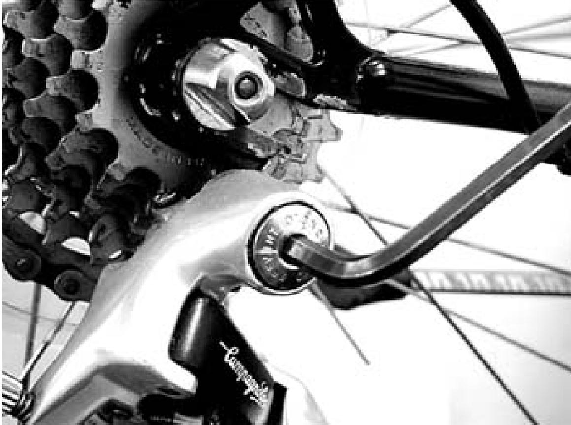
Abb. 7: Schaltwerk festziehen
