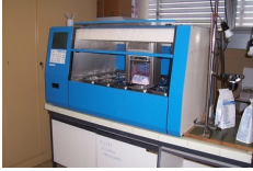
Abb. 1: { In diesem Auto- maten werden die Präparate ent- wässert und mit Paraffin behandelt.
