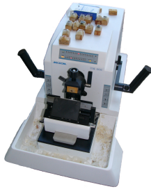
Abbildung 5: Elektrisches Mikrotom mit Paraffinblöcken.
