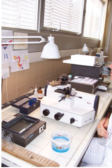
Abbildung 4: An dieser Station werden mit dem Mikrotom vom Paraffinblock Schnitte angefertigt und auf Objektträger aufgezogen.
