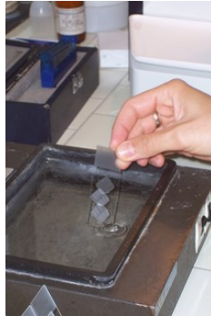
Abbildung 8: Das Aufziehen der hauchdünnen Schnitte.
