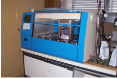
Abbildung 1: In diesem Automaten werden die Präparate entwässert und mit Paraffin behandelt.
