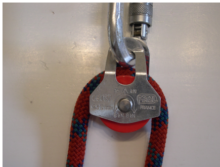
Abb. 93 Seilrolle mit Einfachseil
