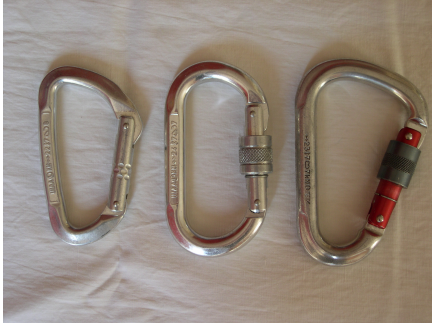
Abb. 46 Karabinerformen: D-förmig, oval, birnenförmig
