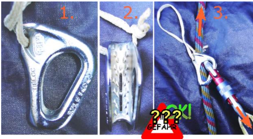
Abb. 99 Tibloc von außen, von innen und in Aktion (Achtung: falscher Gebrauch, Seil läuft nur durch Tibloc, aber nicht durch Karabiner! Richtige Verwendung siehe Bild weiter unten)
