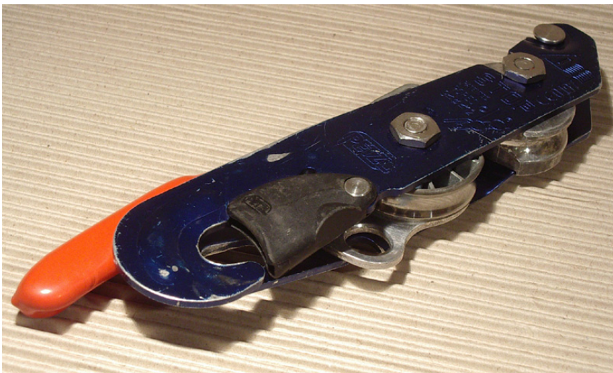
Abb. 84 Selbstblockierendes Abseilgerät Petzl Stop
