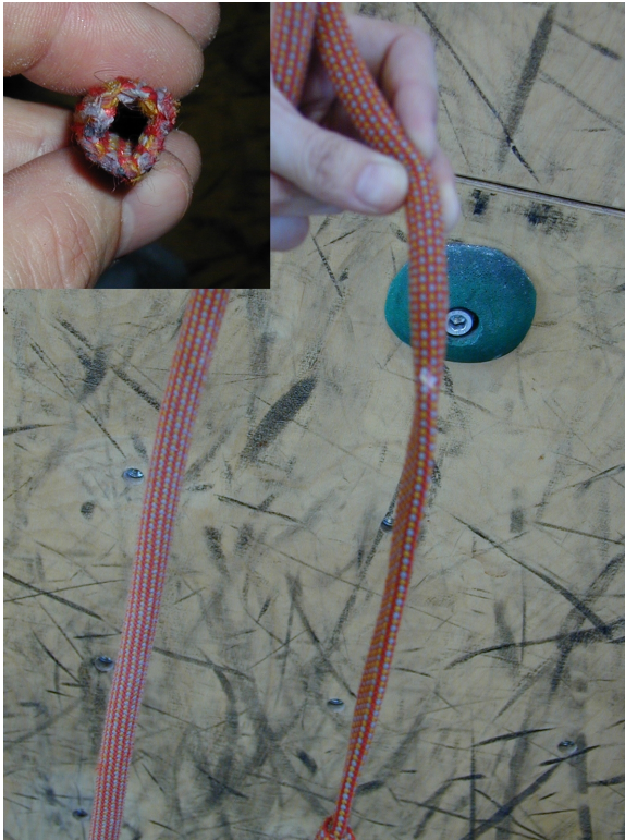
Abb. 35 Seil mit zurückgezogenem Kern.
