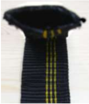
Abb. 38 Schlauchband im Querschnitt
