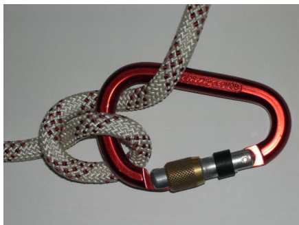
Abb. 65 HMS-Karabiner mit Halbmastwurf
