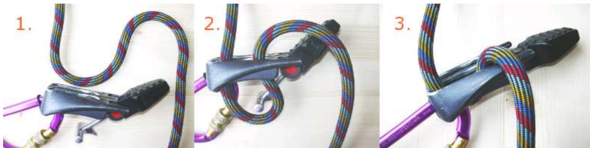
Abb. 77 Einlegen des Seils in den Tre Sirius
