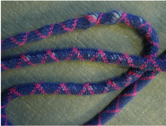
Abb. 34 Seil mit verschlissenem Mantel.
