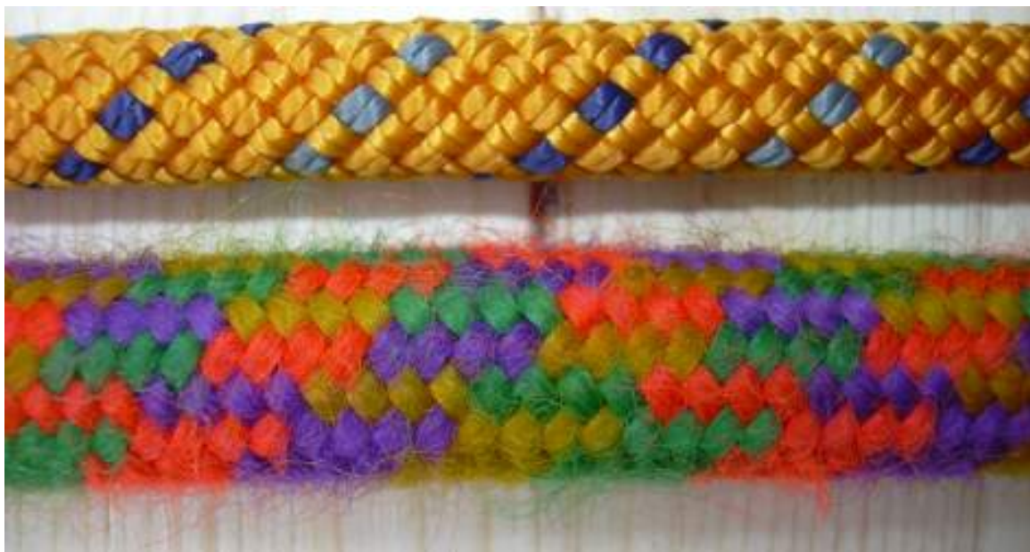
Abb. 180 Seilpelz beim unteren Seil
