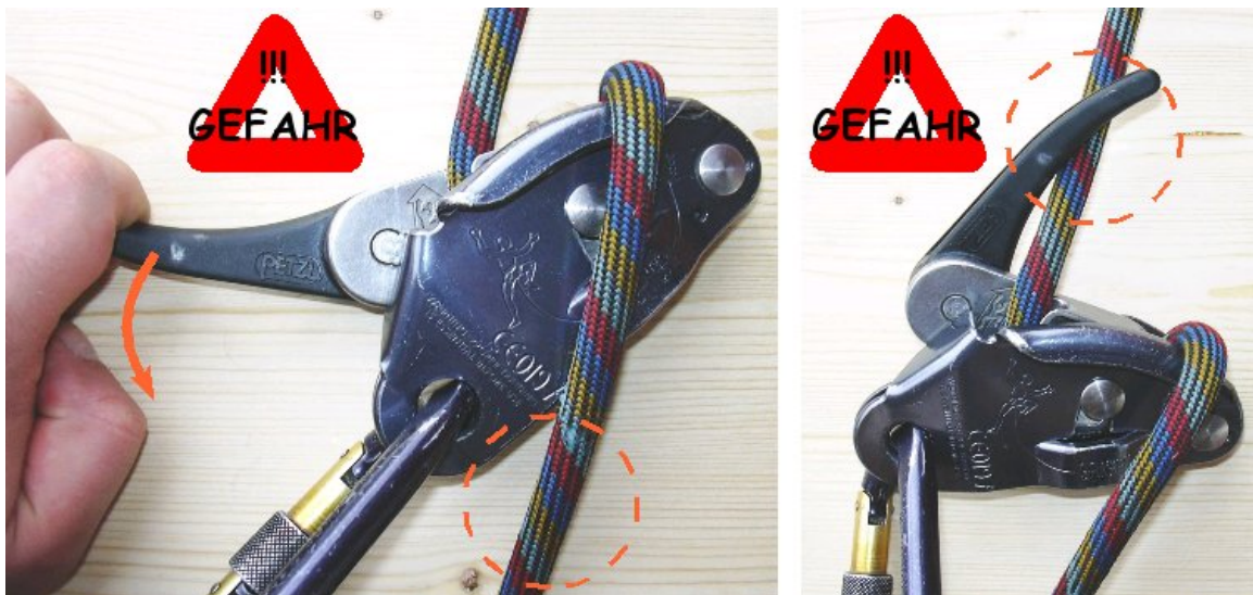
Abb. 72 Entriegeln des statisch blockierten Grigri
