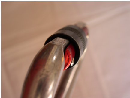
Abb. 52 Die Schraubhülse ist kein tragendes Element
