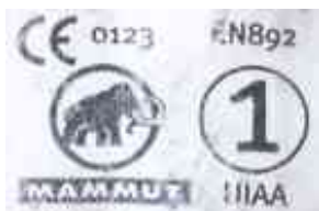
Abb. 29 Banderole eines Einfachseils
