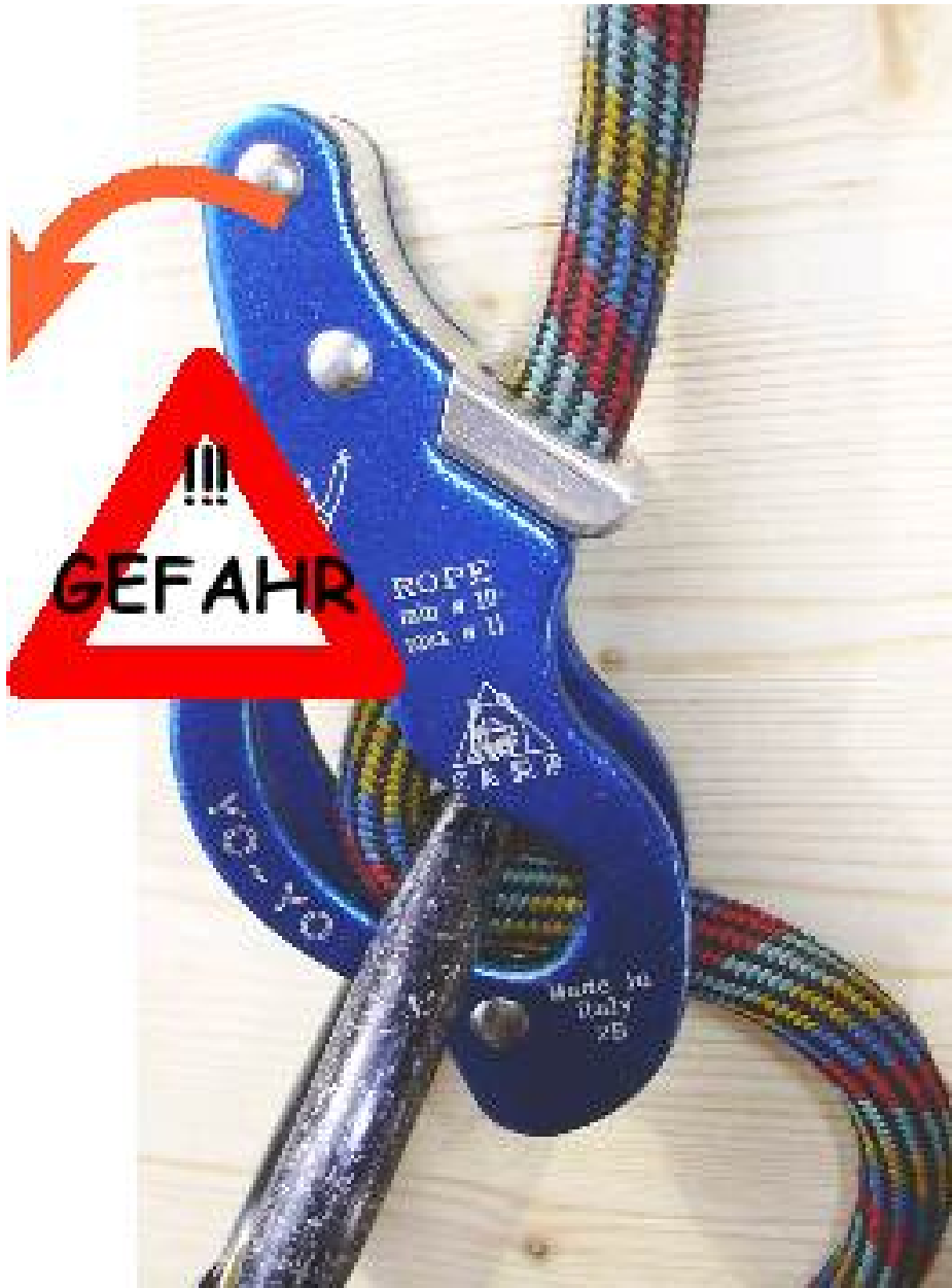
Abb. 80 Entriegeln eines blockierten Yoyo
