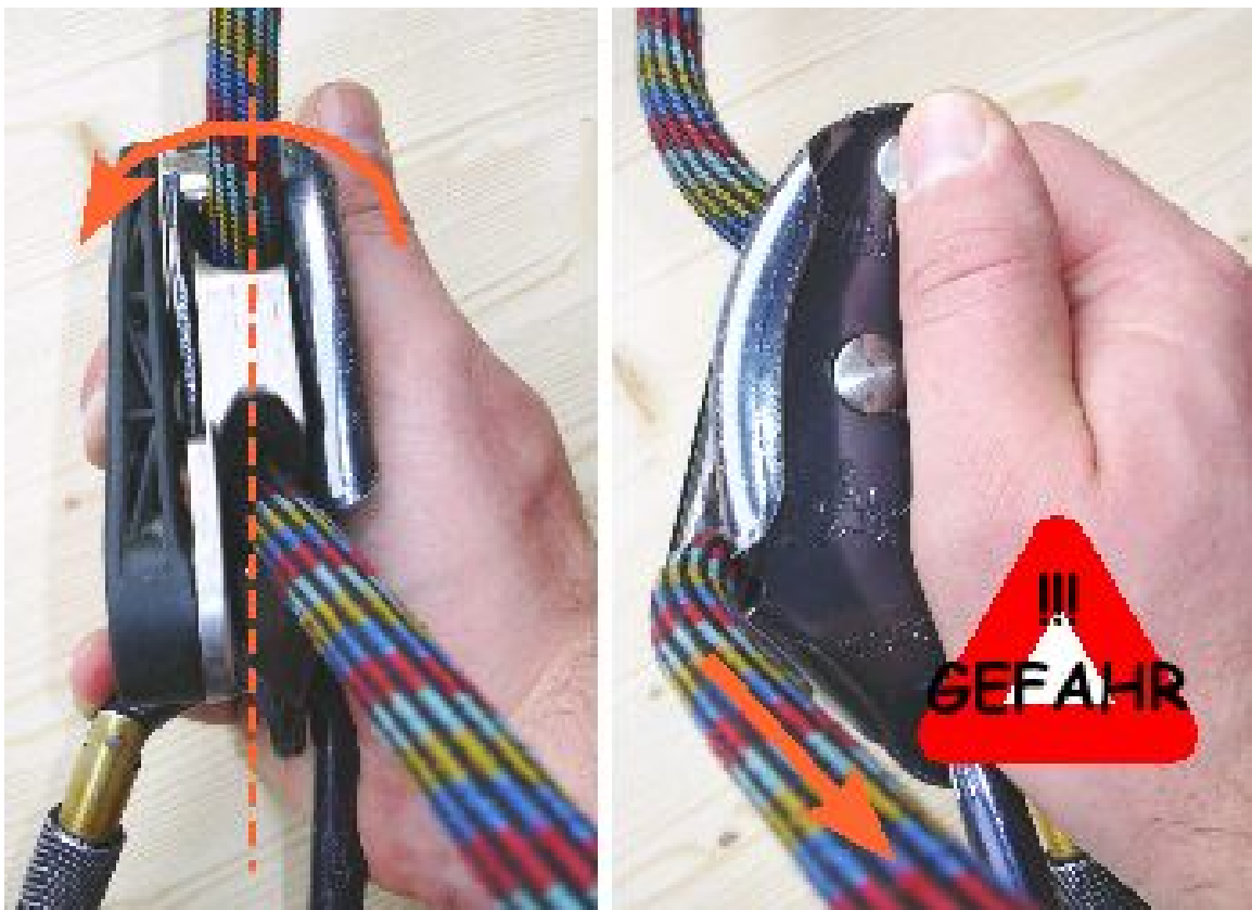
Abb. 73 Kippen des blockierten Grigri um die Längsachse
