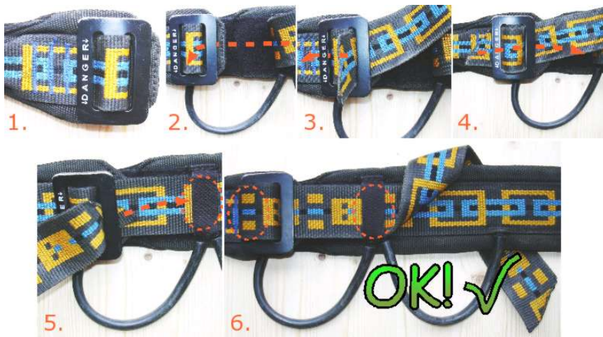
Abb. 13 Verstellen einer Schnalle mit Zurückschlaufen
