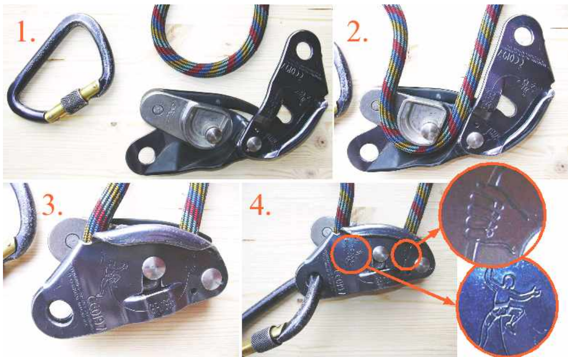
Abb. 70 Einlegen des Seils in den Grigri
