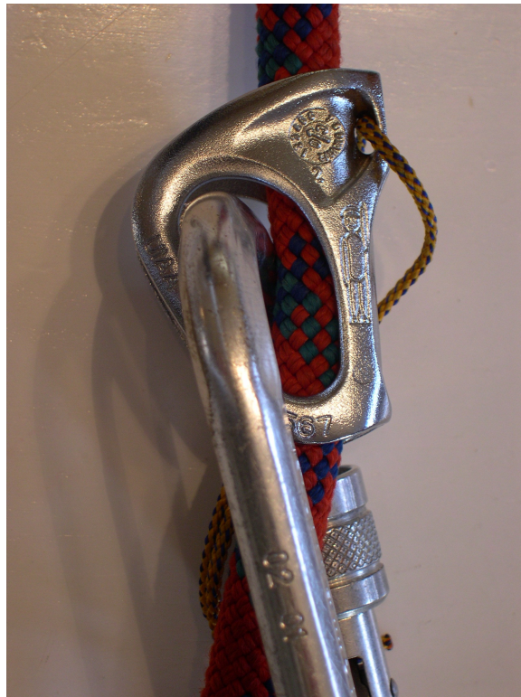
Abb. 117 Tibloc mit Karabiner, richtiger Gebrauch (Seil muss durch Karabiner laufen!)
