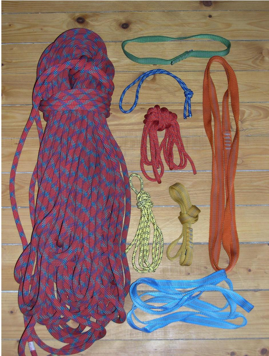
**Abb. 20** Einfachseil, Bandschlingen und Reepschnüre
