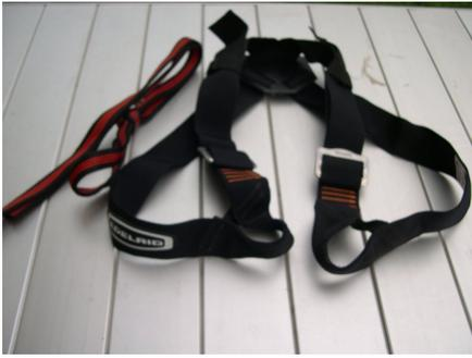
**Abb. 11** Verstellbarer Brustgurt in Achterform mit Bandstück zum Einbinden.
