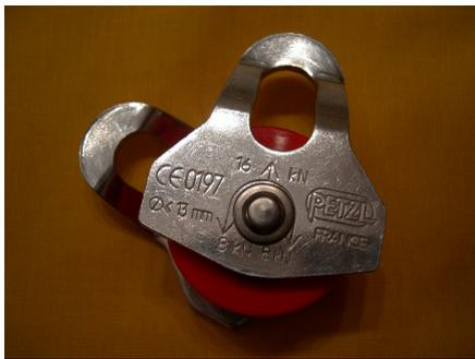
**Abb. 107** Einfache Seilrolle von Petzl
