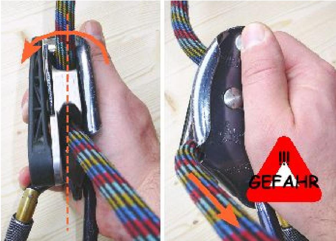
**Abb. 73** Kippen des blockierten Grigri um die Längsachse
