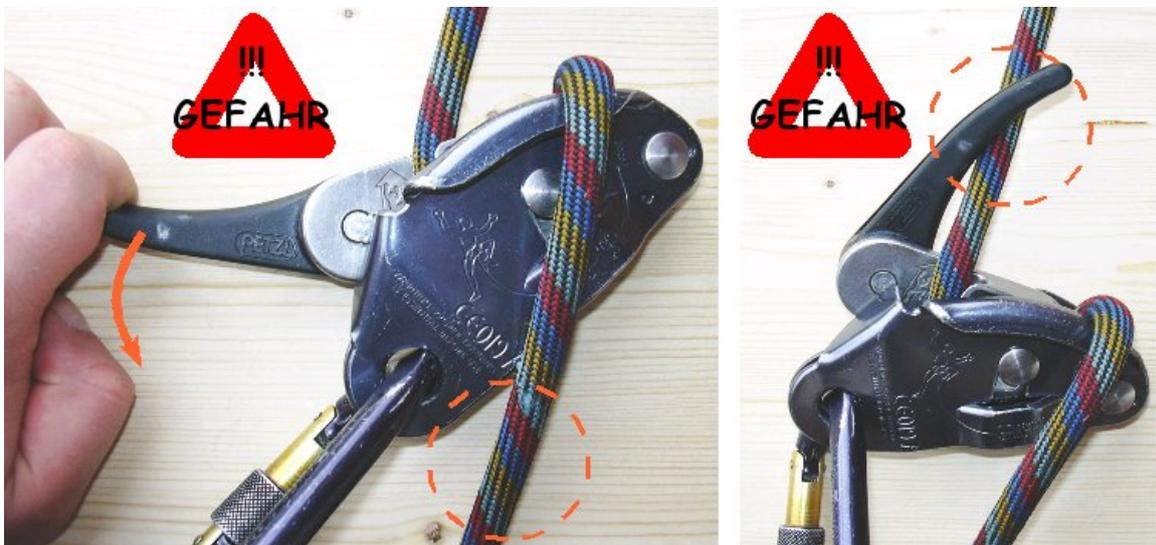
**Abb. 72** Entriegeln des statisch blockierten Grigri
