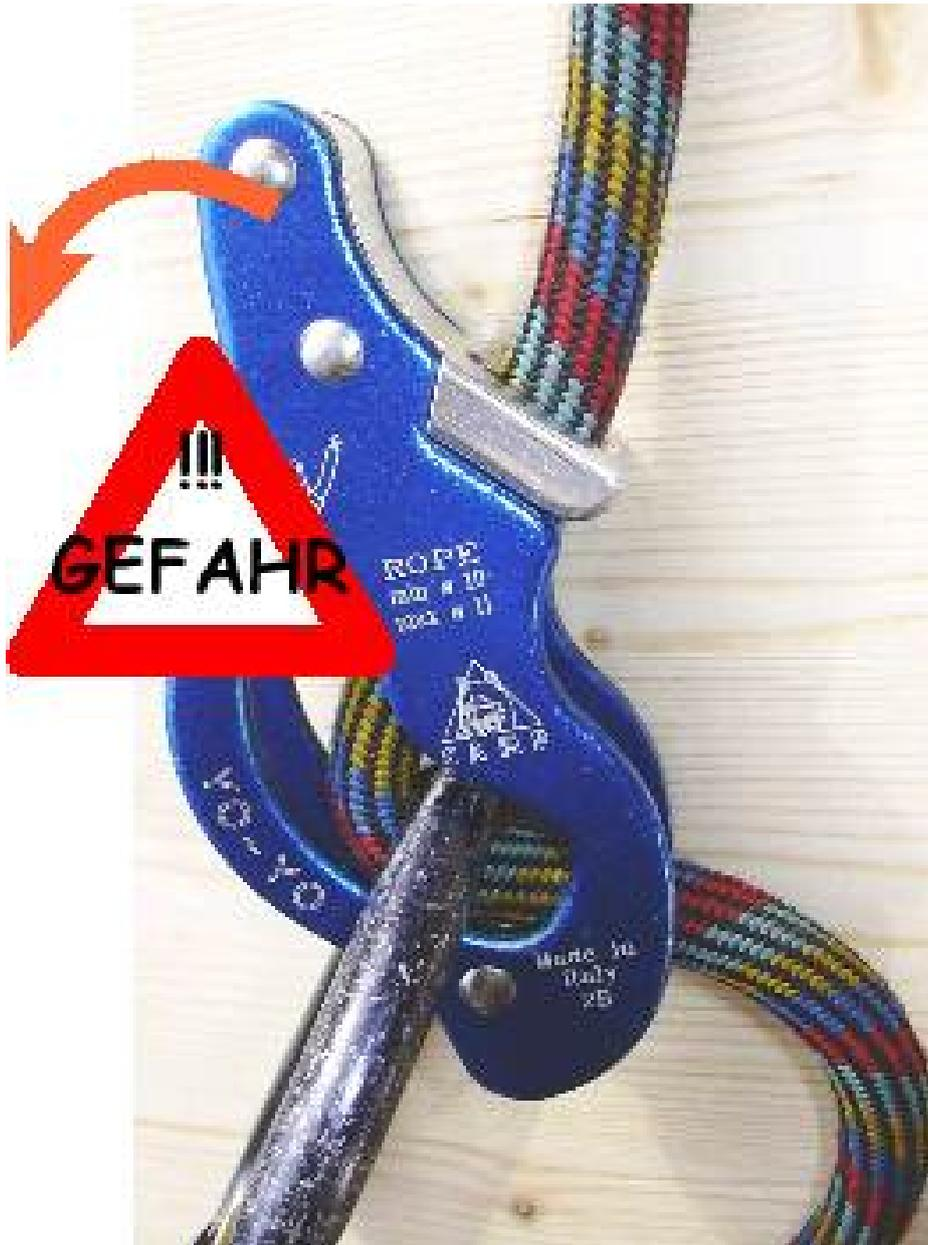
Abb. 80 Entriegeln eines blockierten Yoyo
