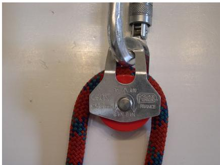
**Abb. 93** Seilrolle mit Einfachseil
