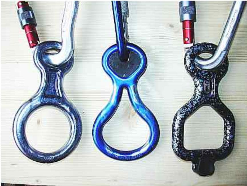
**Abb. 67** Verschiedene Bauformen des Abseilachters: Standardform, v-förmig, eckig
