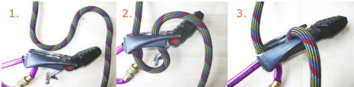
**Abb. 77** Einlegen des Seils in den *Tre Sirius*
