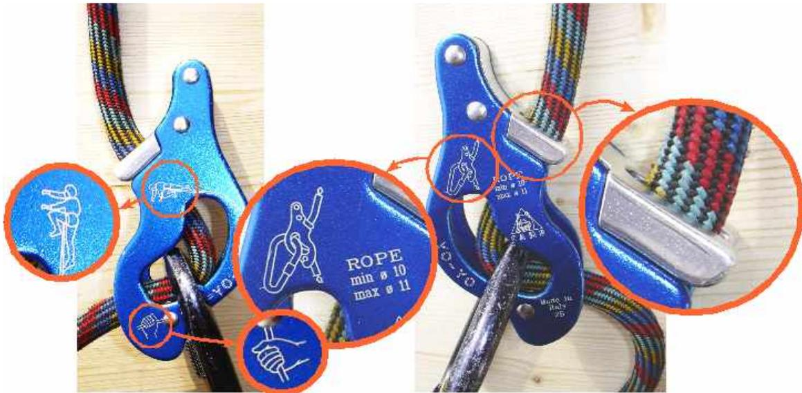
**Abb. 79** Klemmwirkung des Yoyo und aufgedruckte Piktogramme
