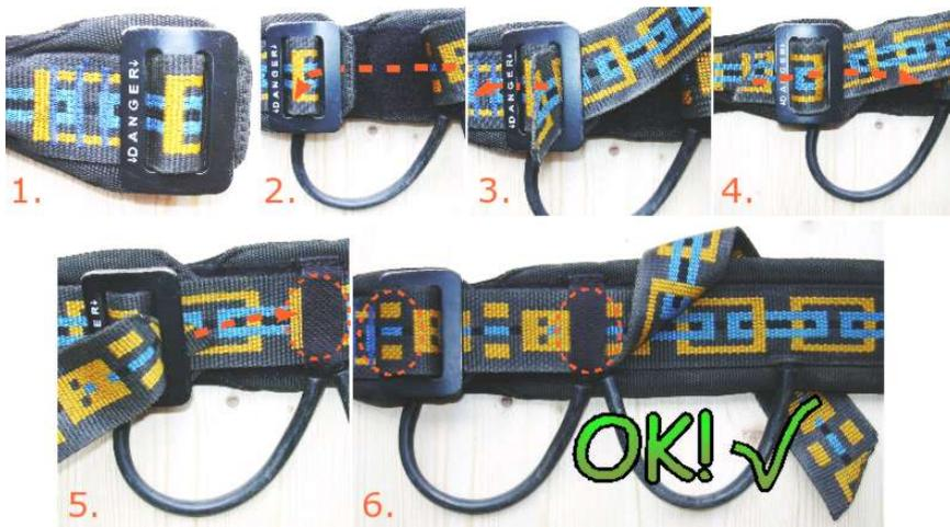
**Abb. 13** Verstellen einer Schnalle mit Zurückschlaufen
