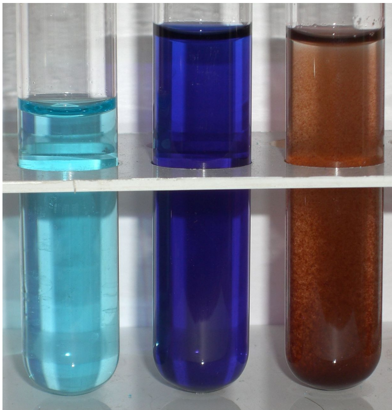
Abb. 49: \text{CuSO}_4 (links), Nachweis als \text{Cu}(\text{NH}_3)_4 (tiefblau) als \text{Cu}_2[\text{Fe}(\text{CN})_6] (braunrot)
