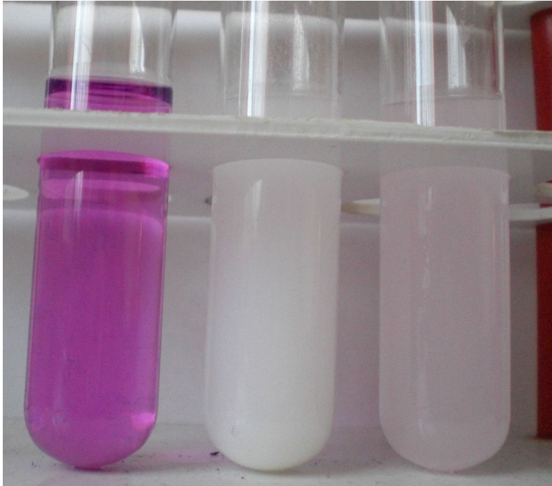
Abb. 61: links: Permanganat; mitte: Lösung entfärbt, Bariumsulfat gefällt; rechts: Reaktion zu langsam
