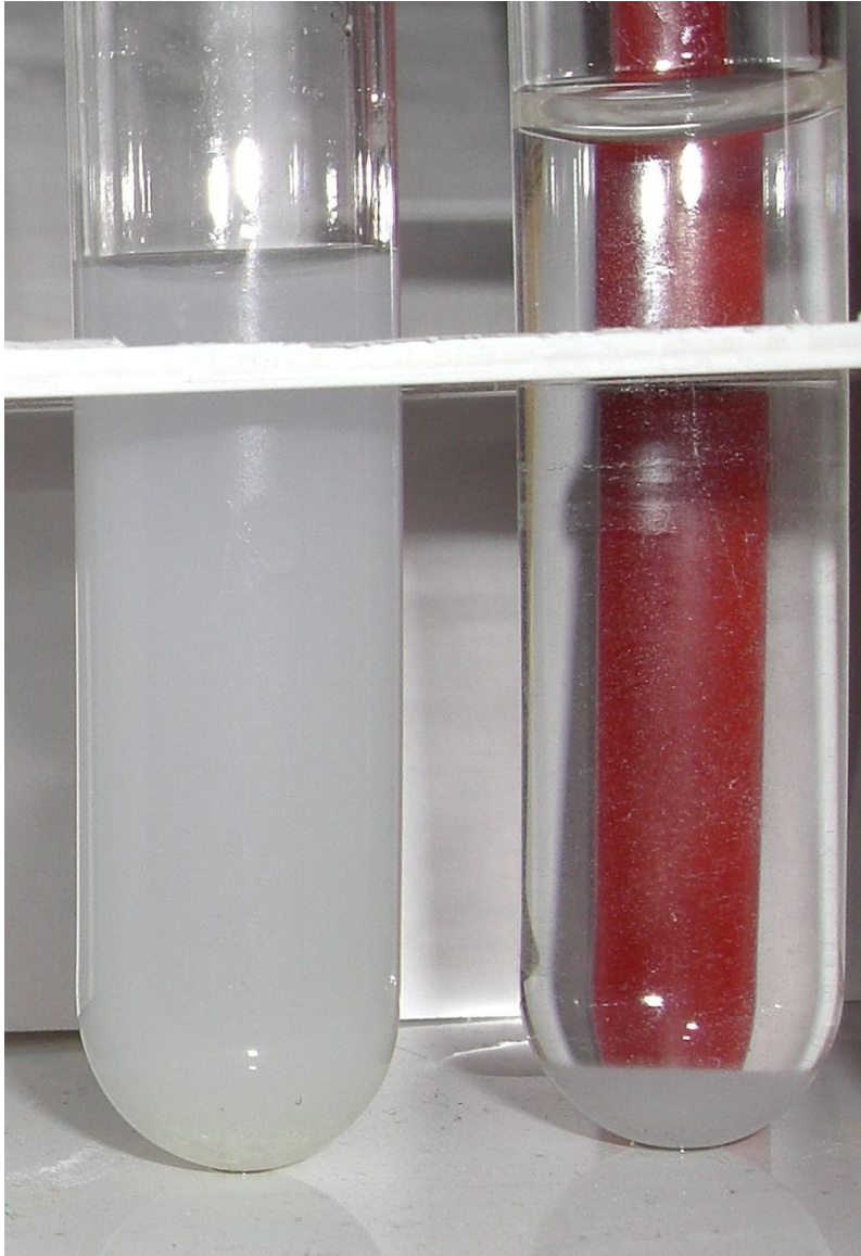
Abb. 59: AgCl als weißer NS; rechts: AgCl gelöst in Ammoniakwasser
