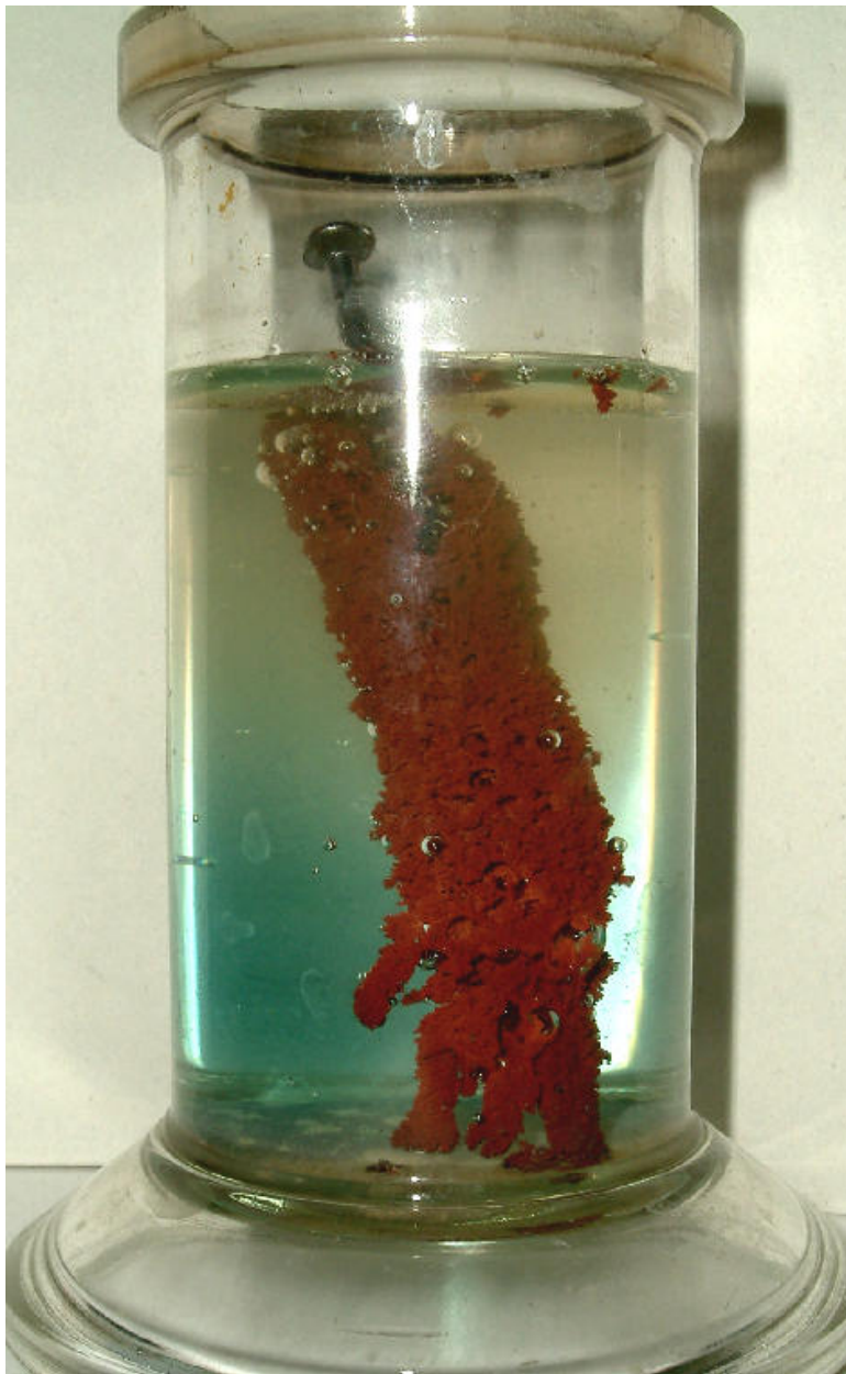
Abb. 158 Eisennagel in Kupfer(II)-Sulfatlösung
