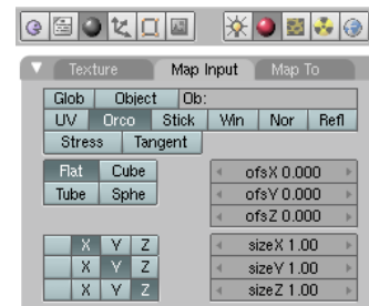
Abb. 744: Abbildung 2e: Auf dem Map Input Panel wird festgelegt, wo die Textur platziert wird. In diesem Fall sehr einfach, da die Fläche bereits zum Bild passt.
