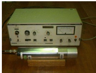
Abbildung 42: Ein Einkanalanalysator mit einem Kristall-Photomultiplier-Aufbau.
