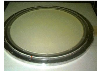
Abbildung 52: Der NaI Kristall einer Gammakamera.
