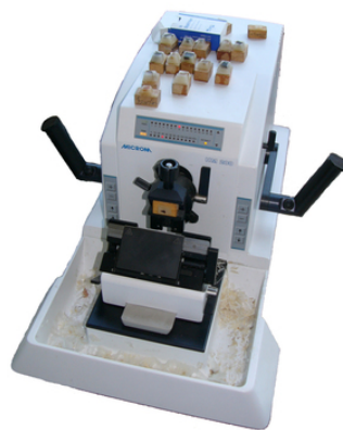
Abb. 5: Elektrisches Mikrotom mit Paraffinblöcken.
