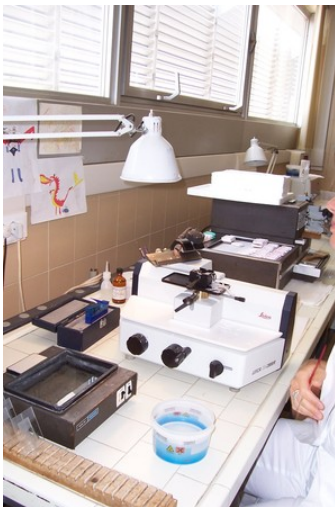
Abb. 4: An dieser Station werden mit dem Mikrotom vom Paraffinblock Schnitte angefertigt und auf Objektträger aufgezogen.
