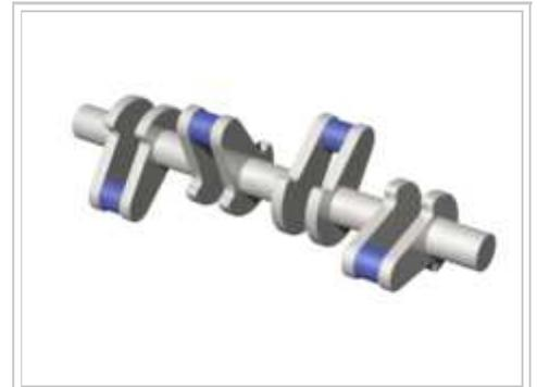
Darstellung der Kurbelwelle: Die Kurbelzapfen sind blau eingefärbt, welche die einzelnen Kurbelwangen miteinander verbinden. Die einzelnen Teile werden durch die Wellenzapfen verbunden.
