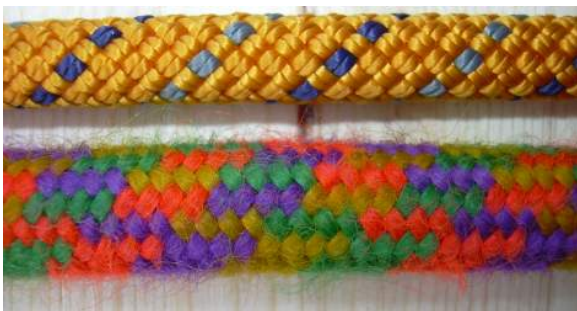
Abb. 33 Neues und gebrauchtes Seil mit Seilpelz.
