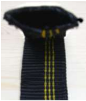
Abb. 38 Schlauchband im Querschnitt
