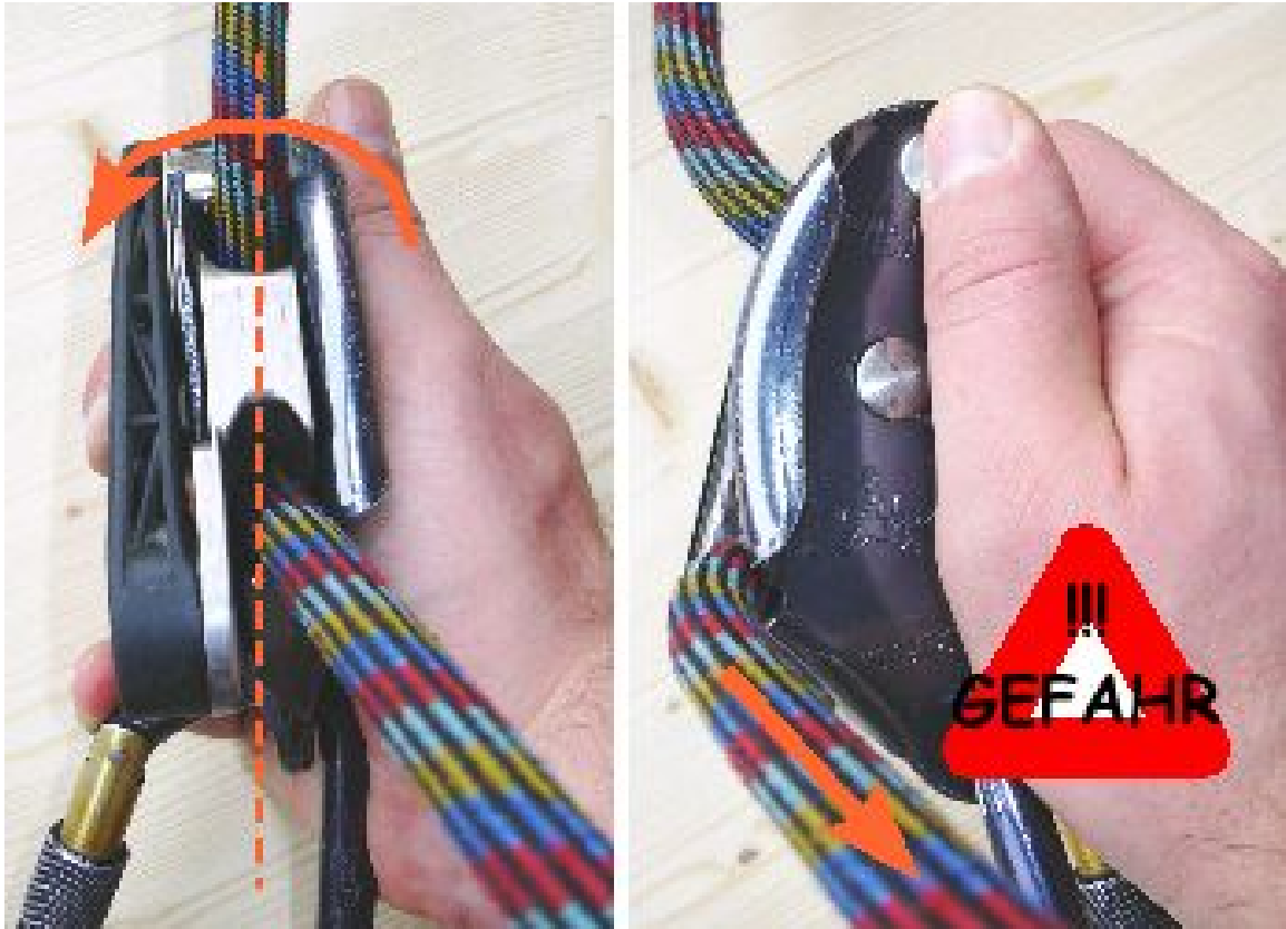
Abb. 73 Kippen des blockierten Grigri um die Längsachse
