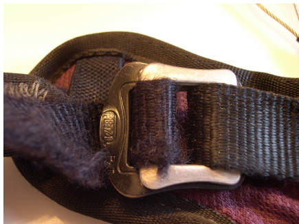
Abb. 14 Die verstellbare Doubleback-Schnalle lässt sich nicht vollständig öffnen.
