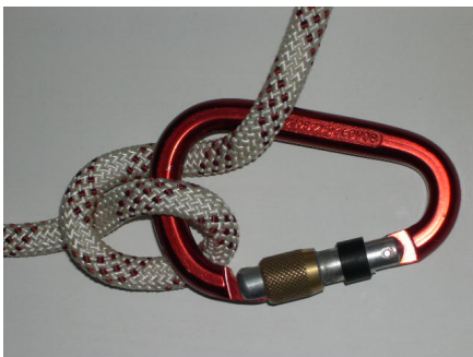
Abb. 65 HMS-Karabiner mit Halbmastwurf
