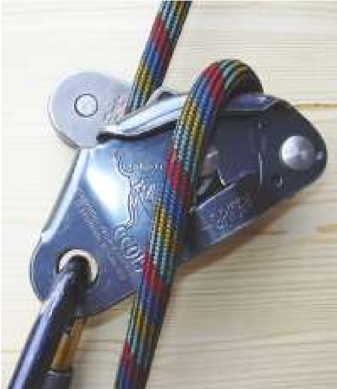
Abb. 71 Korrekt blockierender Grigri
