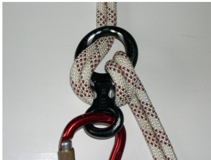
Abb. 156 Abseilachter mit eingelegtem Seil und Karabiner
