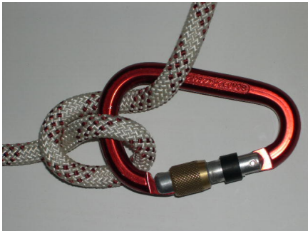
Abb. 47 HMS-Karabiner mit Halbmastwurf
