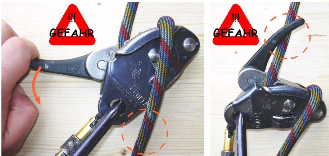
Abb. 72 Entriegeln des statisch blockierten Grigri
