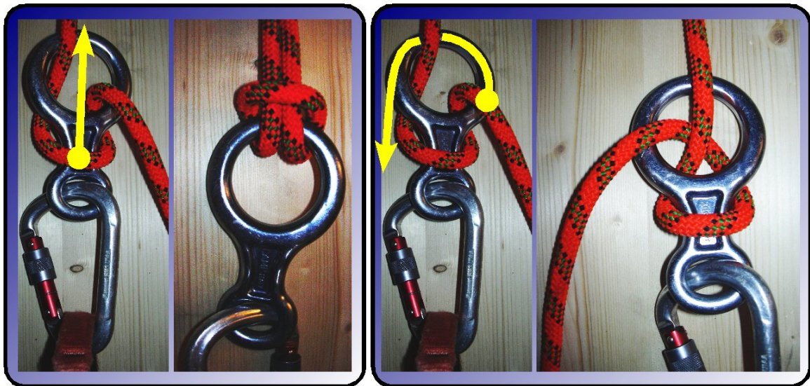
Abb. 165 Sperren / Blockieren des Abseilachters durch Umschlagen in den Ankerstich (links), Sperren / Blockieren durch vollständiges Kreuzen des Hand- und Lastseils (rechts)
