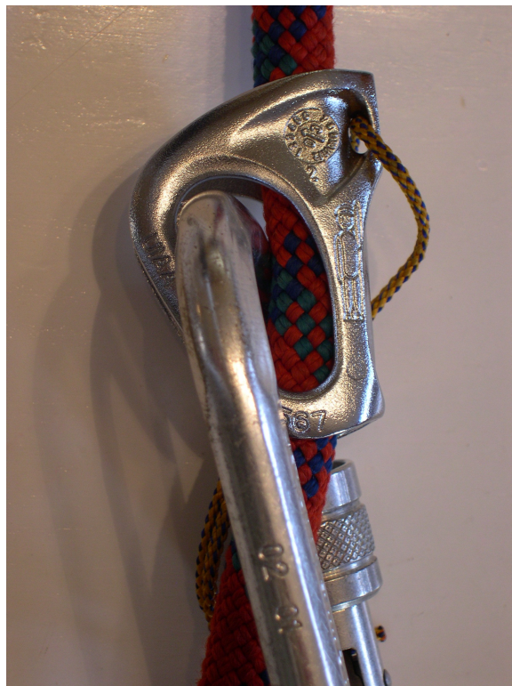
Abb. 102 Tibloc mit Karabiner, richtiger Gebrauch (Seil muss durch Karabiner laufen!)
