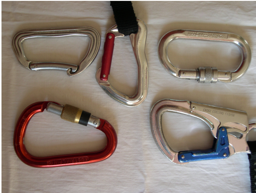
Abb. 57 Karabiner Typ B, D, X, H und K, Typ Q fehlt
