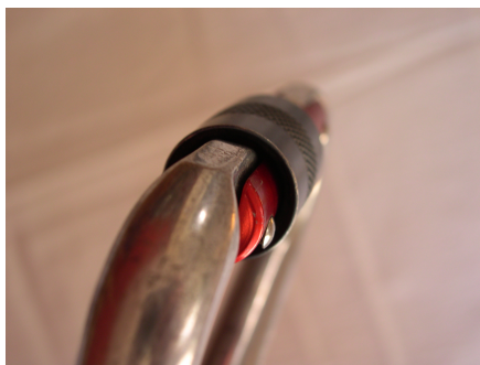
Abb. 52 Die Schraubhülse ist kein tragendes Element
