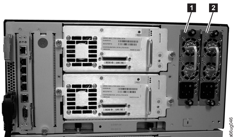
図 11-1. 制御モジュール内の電源機構
