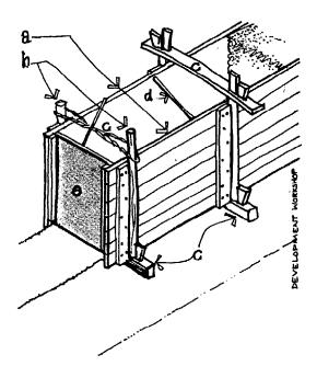
FIG 6.14 BASIC ELEMENTS OF FORMWORK
