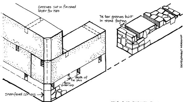
FIG. 6.19. RAMMED EARTH WALLING
