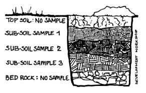
FIG. 4.1. SAMPLES FROM A TRIAL HOLE
