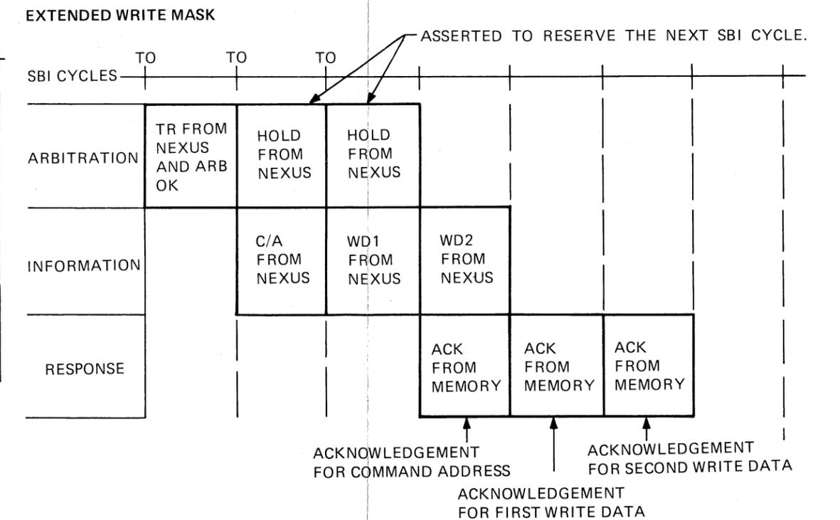
\* THE SBI INTERLOCK LINE IS USED ONLY DURING INTERLOCK READ MASKED AND INTERLOCK WRITE MASKED OPERATIONS. THE COMMAND SEQUENCE OF EACH OF THESE OPERATIONS IS IDENTICAL TO A READ MASKED AND EXTENDED READ OPERATION, RESPECTIVELY.
