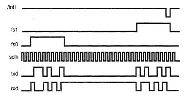
Figure 10. CODEC Interface Timing (8-Bit Mode)
