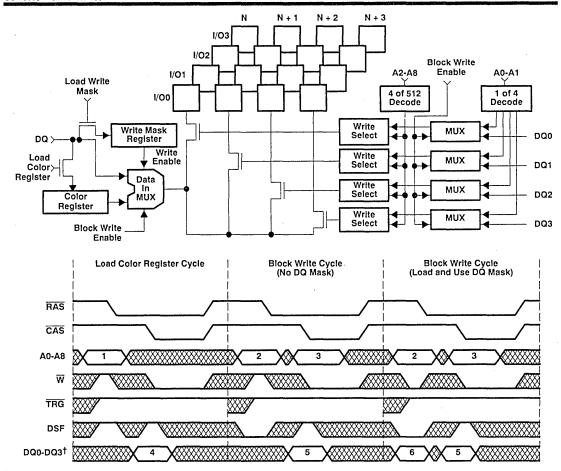
$^\dagger$  DQ0-DQ3 ( $\overline{\text{CAS}}$ ) are latched on the later of  $\overline{\text{W}}$  or  $\overline{\text{CAS}}$  falling edge. DQ0-DQ3 ( $\overline{\text{RAS}}$ ) are latched on  $\overline{\text{RAS}}$  falling edge. Legend:
