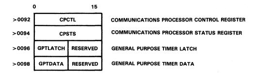
FIGURE 1. TMS38010 CONTROL REGISTERS
