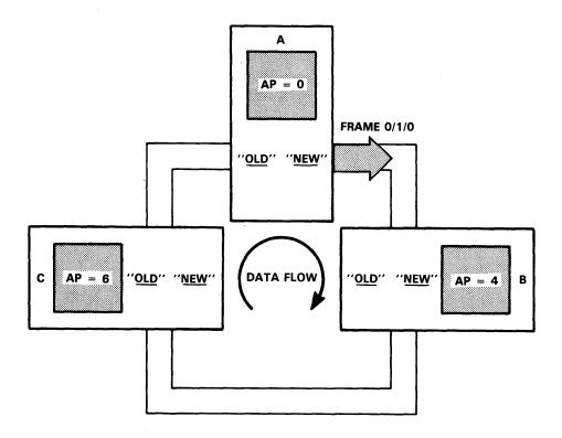
FIGURE 3-22. STATION A CAPTURES TOKEN AND BEGINS TRANSMISSION OF FRAME
