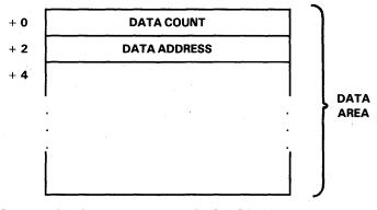
FIGURE 4-66. READ ADAPTER SYSTEM BUFFER SPACE
