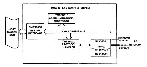
FIGURE 1-9. INTEGRATED ADAPTER ARCHITECTURE
