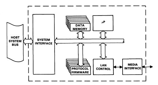
FIGURE 1-8. LAN CONTROLLER-BASED ADAPTER CARD ARCHITECTURE
