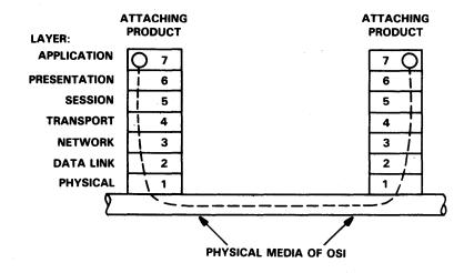
FIGURE 1-2. THE OSI REFERENCE MODEL
