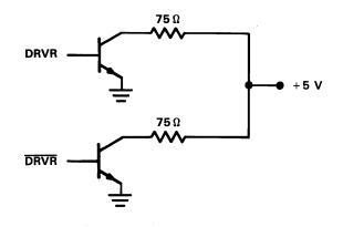
FIGURE 4-70. TMS38051 LINE DRIVER STAGE
