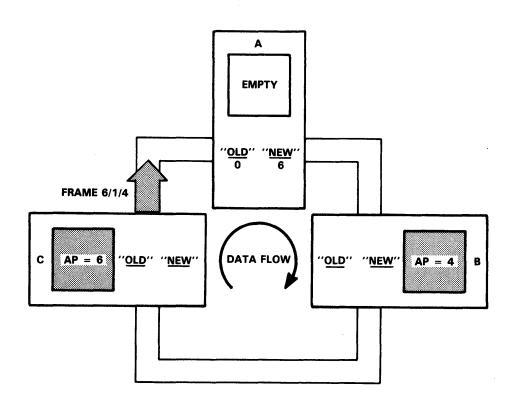
FIGURE 3-28. STATION C CAPTURES TOKEN AND BEGINS TRANSMISSION OF FRAME
