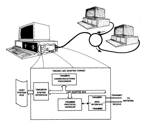
FIGURE 1-1. TMS380 LAN ADAPTER CHIPSET
