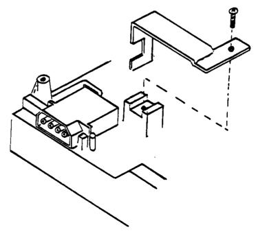
FIGURE 6-4 POWER INPUT PLUG AND BRACKET
