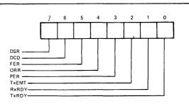
FIGURE 3: COM78C802 STATUS REGISTERS (LINE 0:1) FORMAT
