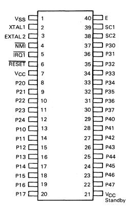
Figure 3-1. MC6801 Pin Diagram
