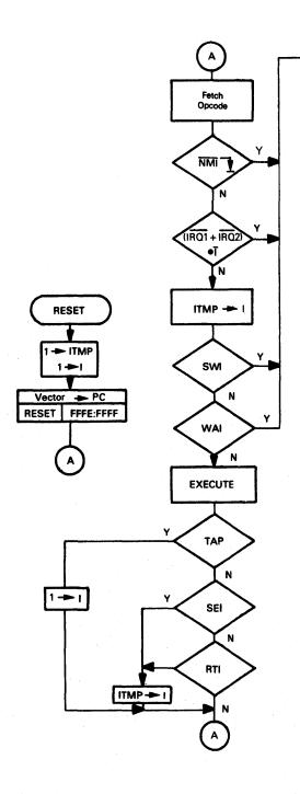
Figure 5-9. MC6801 Non-Interrupt Flowchart
