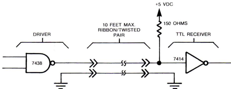
FIGURE 6-1. I/O LINE DRIVER/RECEIVER
