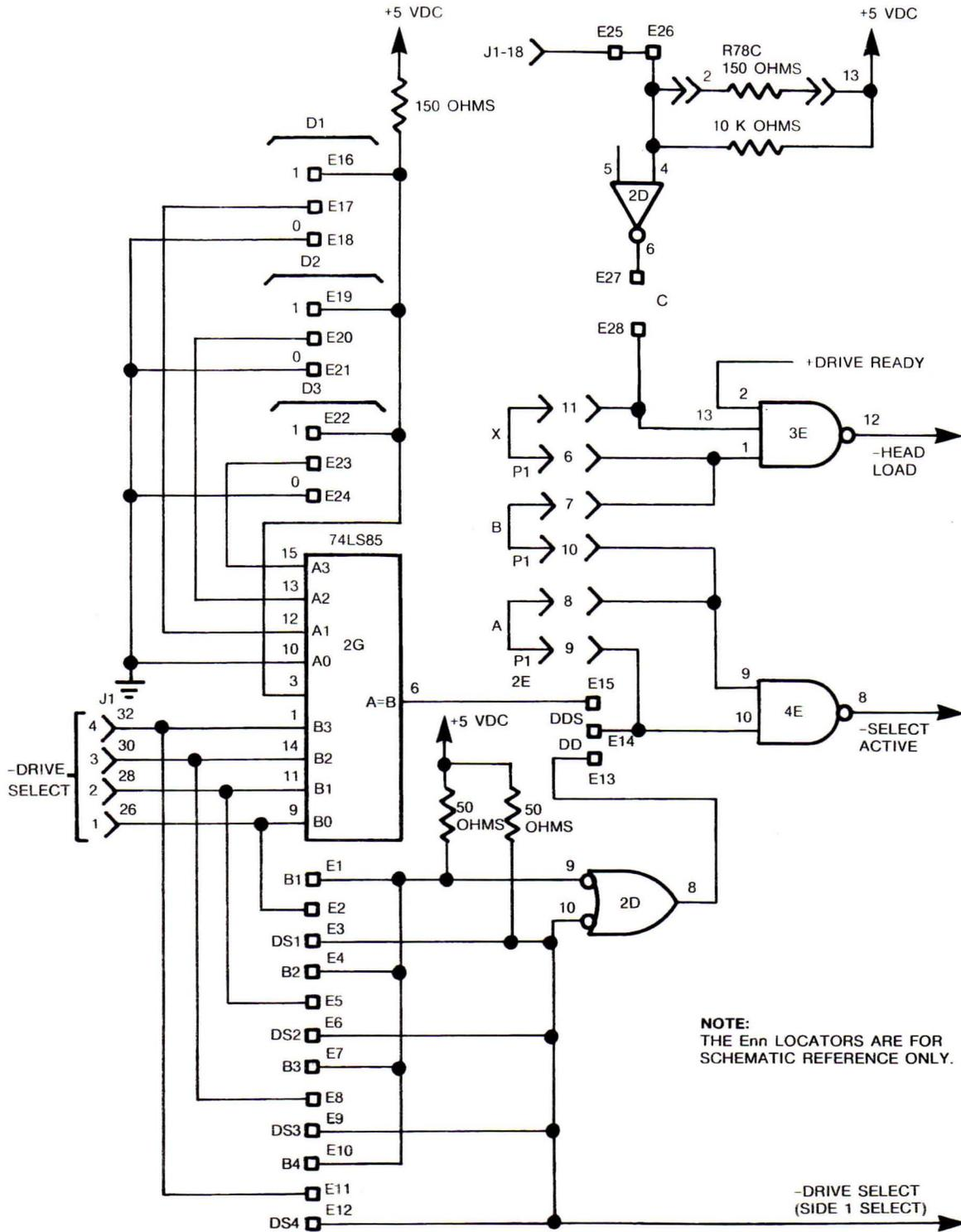
FIGURE 3-6. DRIVE SELECTION (ENCODED) CIRCUITRY
