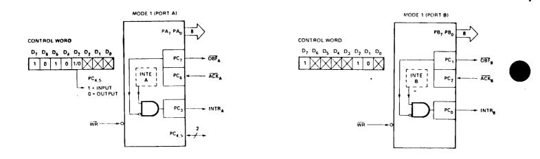
FIGURE 3-21 MODE 1 OUTPUT CONFIGURATION
