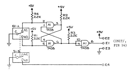
FIGURE 4-1. SYSTEM RESET SWITCH
