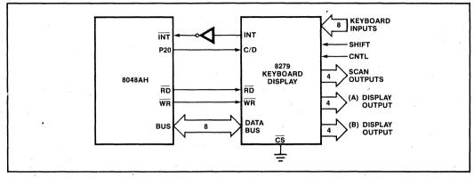
Figure 14-8. Keyboard/Display Interface
