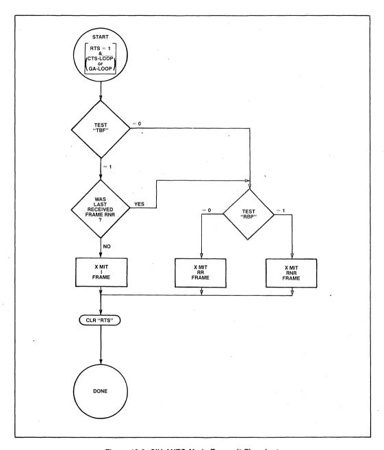
Figure 19-8. SIU AUTO Mode Transmit Flowchart
