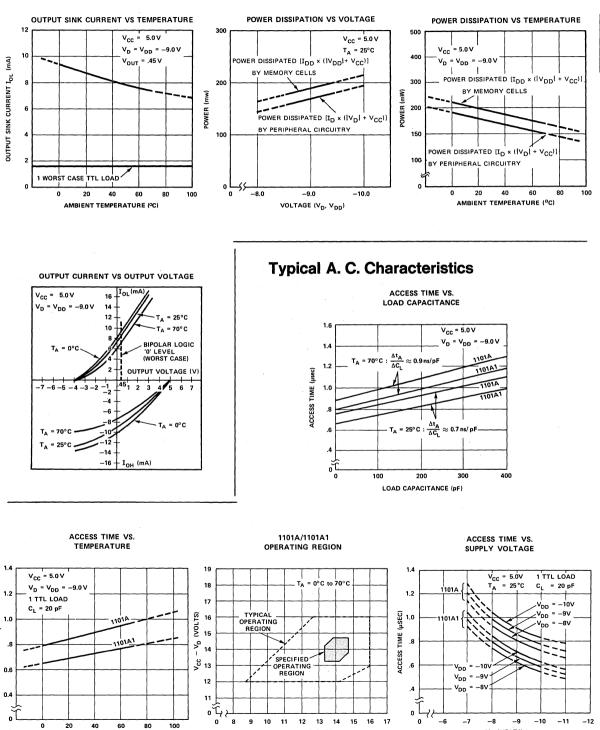
V<sub>CC</sub> - V<sub>DD</sub> (VOLTS)
