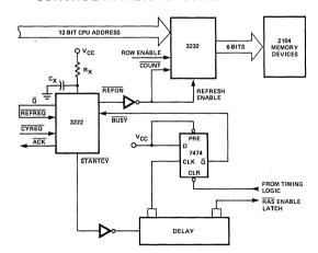
E. TYPICAL APPLICATION OF 3222 REFRESH CONTROLLER IN A 2107B SYSTEM
