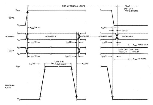
NOTE 1. THE CS/WE TRANSITION MUST OCCUR AFTER THE PROGRAM PULSE TRANSITION AND BEFORE THE ADDRESS TRANSITION.
