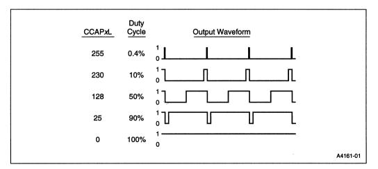
Figure 8-6. PWM Variable Duty Cycle
