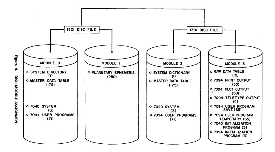
MODULE ASSIGNMENT MADE ON BASIS OF: • OPTIMUM DUPLICATION FOR BACKUP • MAXIMUM RECOVERY CAPABILITY
