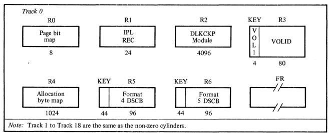
Figure 18. 3330 Cylinder 0 Format
