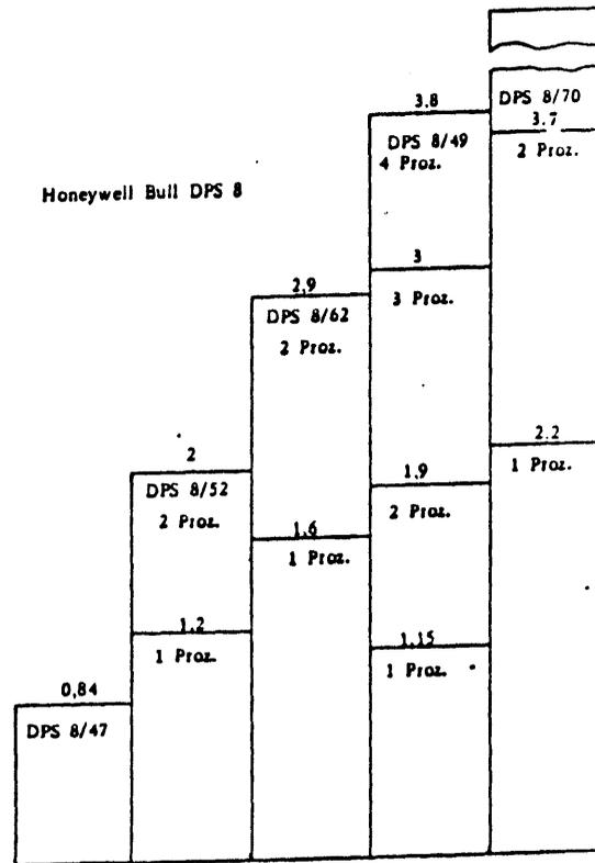
MIPS-LEISTUNGSEINORDNUNG IBM 4300 VS. HB DPS/8
