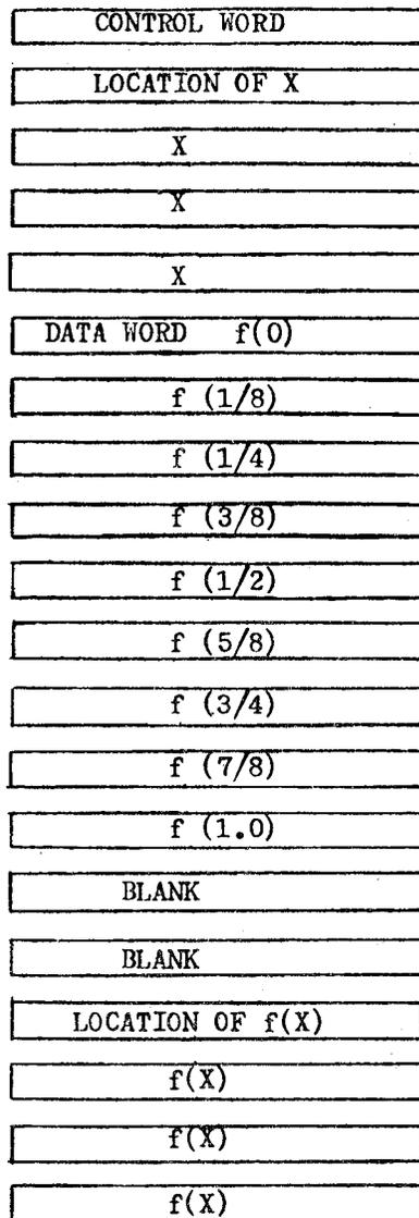
Figure 9 TYPICAL INSTRUCTION SEQUENCE FOR FUNCTION GENERATION
