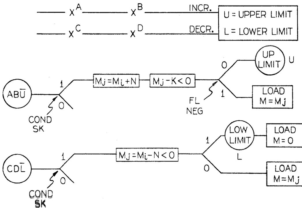
Figure 24 MOTOR DRIVE OPERATION
